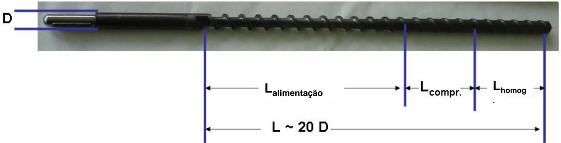
Detalhes do Parafuso da extrusora
