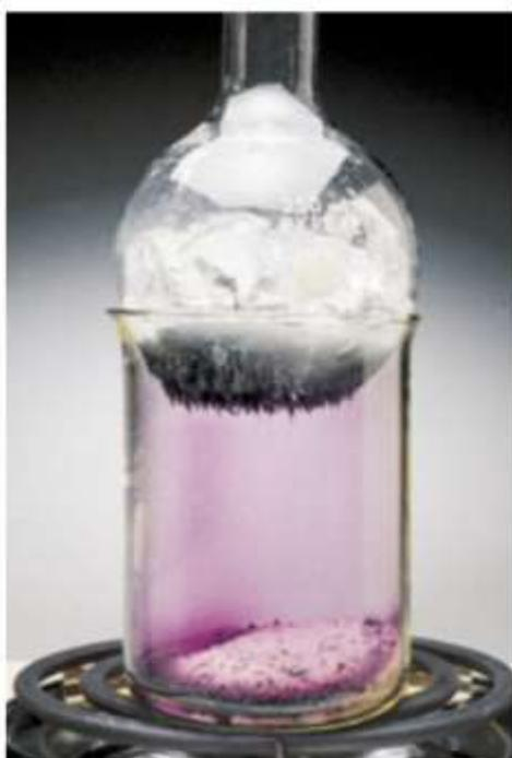
**Figura 13-16** - A sublimação pode ser usada para purificar sólidos voláteis. A alta pressão de vapor da substância sólida o faz sublimar quando aquecido. Cristais da substância purificada são formadas quando o vapor é depositado para formar o sólido na parte mais fria (superior) do aparelho. Iodo,  $I_2$ , sublima facilmente. O vapor  $I_2$  é roxo.
