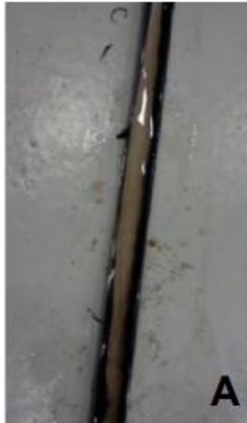
A) Acúmulo de areia nos tubos gotejadores durante ensaio na V1. B) Obstrução do pré-filtro do gotejador ocasionada por partículas da granulometria 3, na V3
