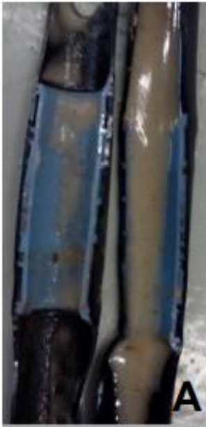
A) Acúmulo de areia nos tubos gotejadores durante ensaio na V1. B) Obstrução do pré-filtro do gotejador ocasionada por partículas da granulometria 3, na V3
