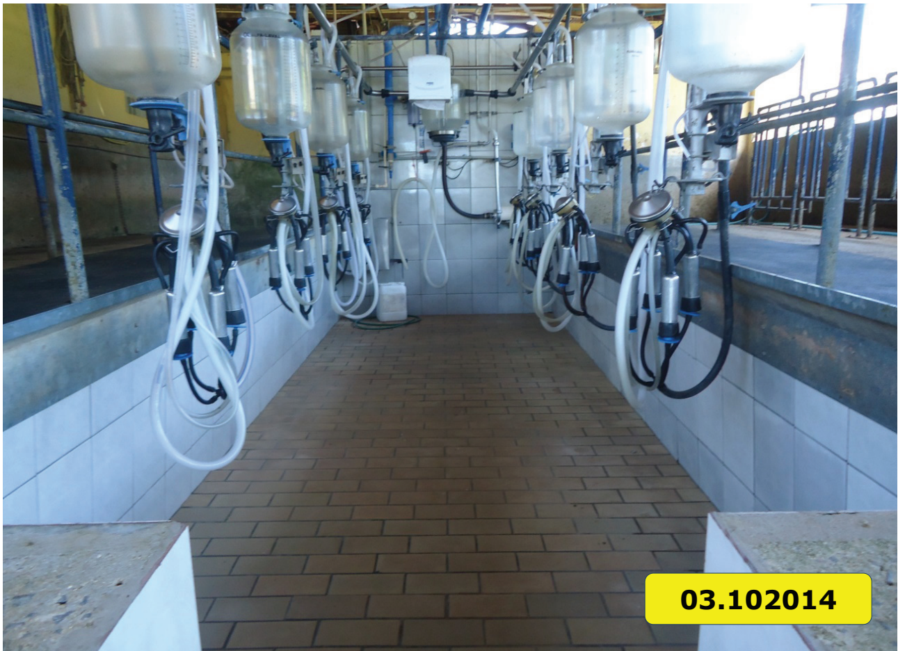
Figura 30. Ampliação dos conjuntos de teteiras de quatro para oito vacas ao mesmo tempo na Fazenda Nata da Serra, em Serra Negra, SP.
