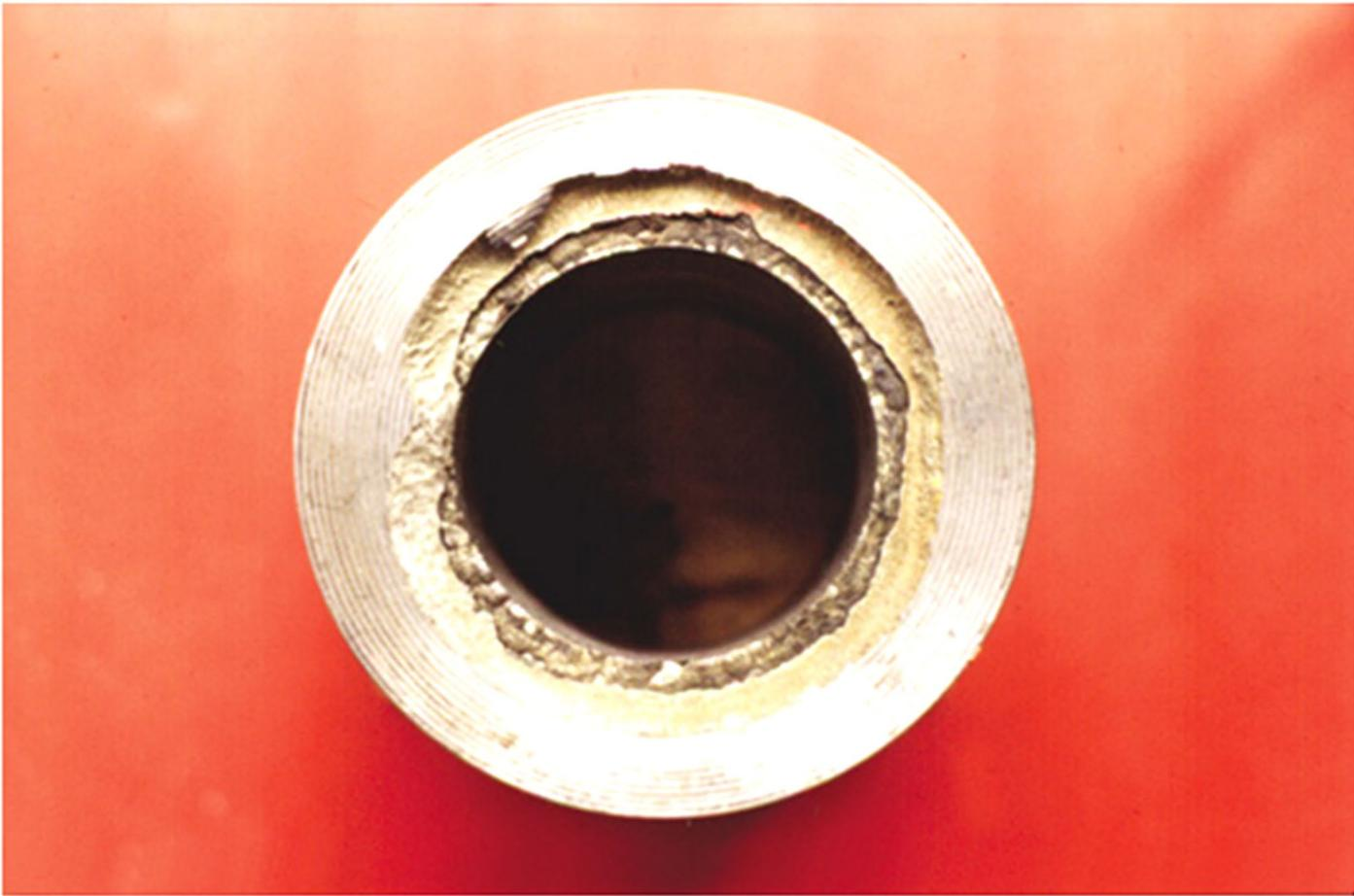
Corrosão por aeração diferencial, em componente de flange, ocasionada por junta que possibilitou a formação de fresta.
