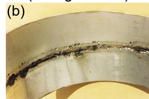
Corrosão em torno de cordão de solda em (a) tanque e (b) tubulação de aço inoxidável AISI 304.
