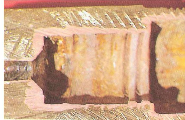
Na corrosão seletiva do ferro fundido cinzento ocorre perda de Fe, restando uma massa porosa, de aspecto escuro (típico do grafite), vazios e ferrugem, facilmente retirável mecanicamente.
