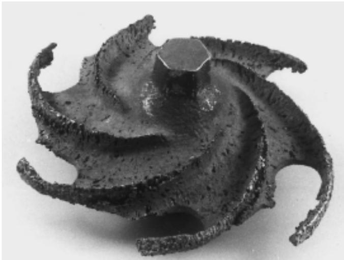
Exemplo de cavitação e corrosão de um rotor de aço inox 316
