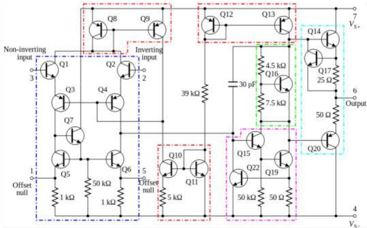
Figura 6 – Diagrama elétrico do AmpOp 741 (Fairchild).
