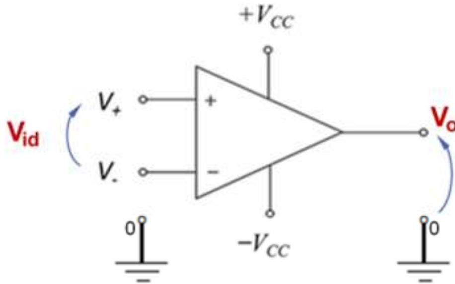
Ganho:  $A = \frac{V_o}{V_{id}} = \frac{V_o}{V_+ - V_-}$
