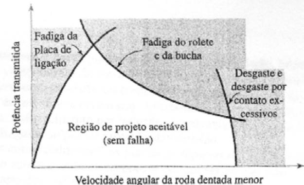
Figura 1 – Região de projeto aceitável limitada pelas curvas de falha de componentes críticos de correntes de precisão (Collins, 2006)
