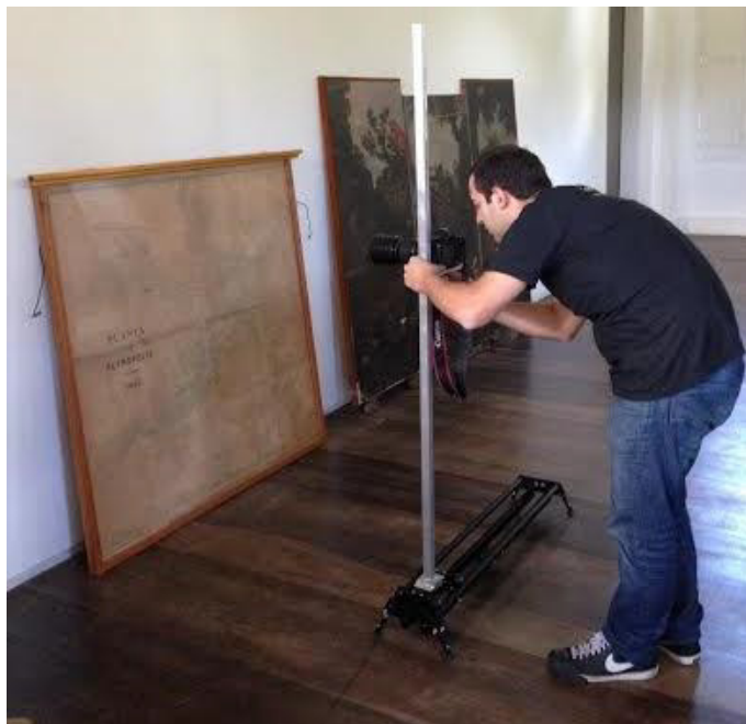
Figura 5. Sistema utilizado com o trilho, haste e câmera digital de alta resolução para o processo de levantamento fotográfico.
