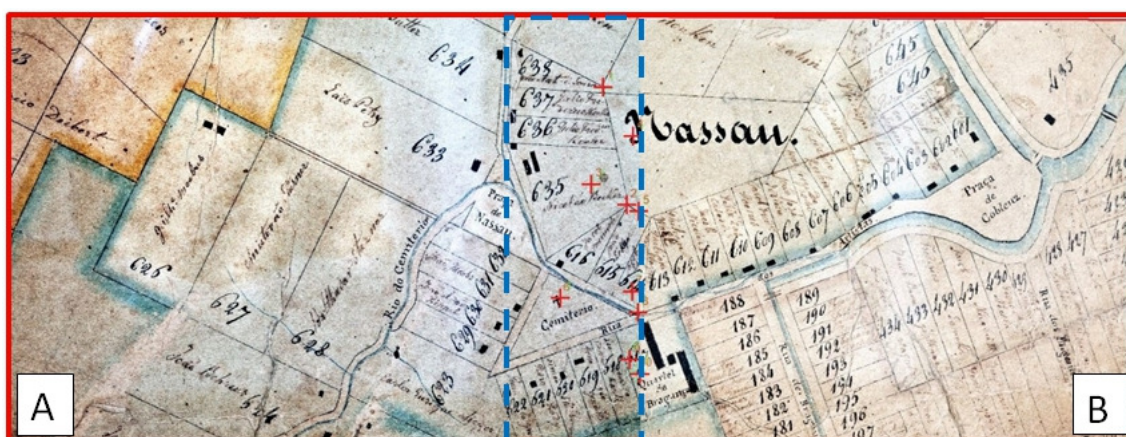
Figura 8. Georreferenciamento do par de fotografias. Em vermelho a área total das duas fotos utilizadas, em azul a área de sobreposição de onde foram extraídos os pontos de controle, e as cruzetas vermelhas são os pontos de controle.
