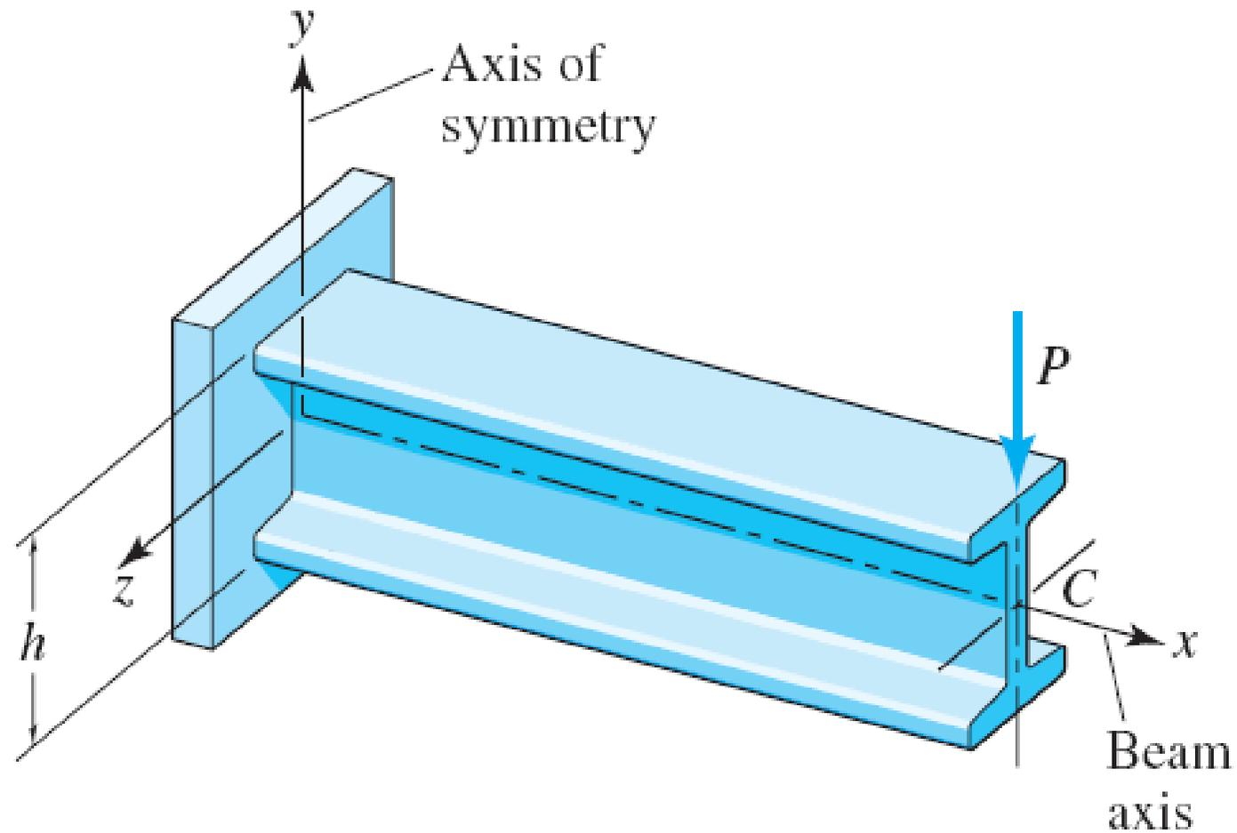
**Uma viga em balanço carregada em seu plano de simetria.**
