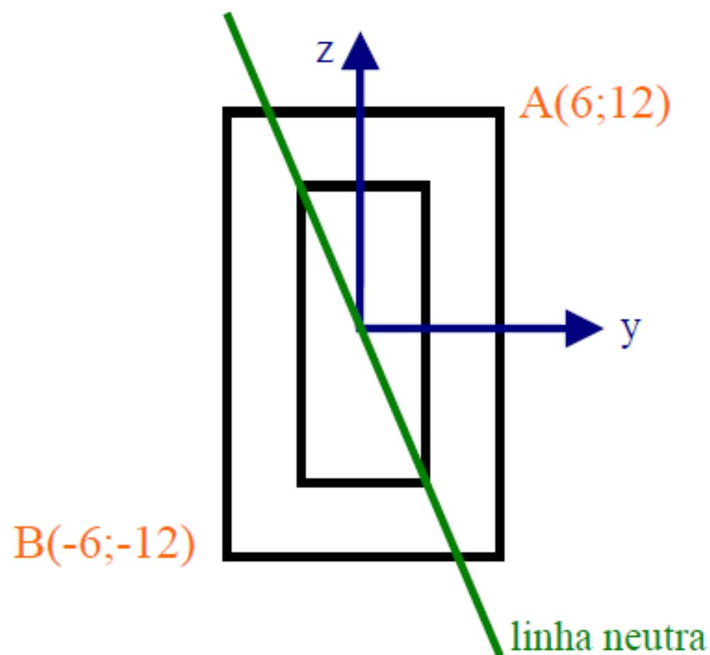
c) As tensões normais extremas são nos pontos A e B:
