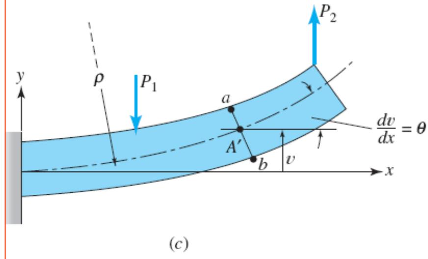
**Viga sujeita a um carregamento transversal:**
