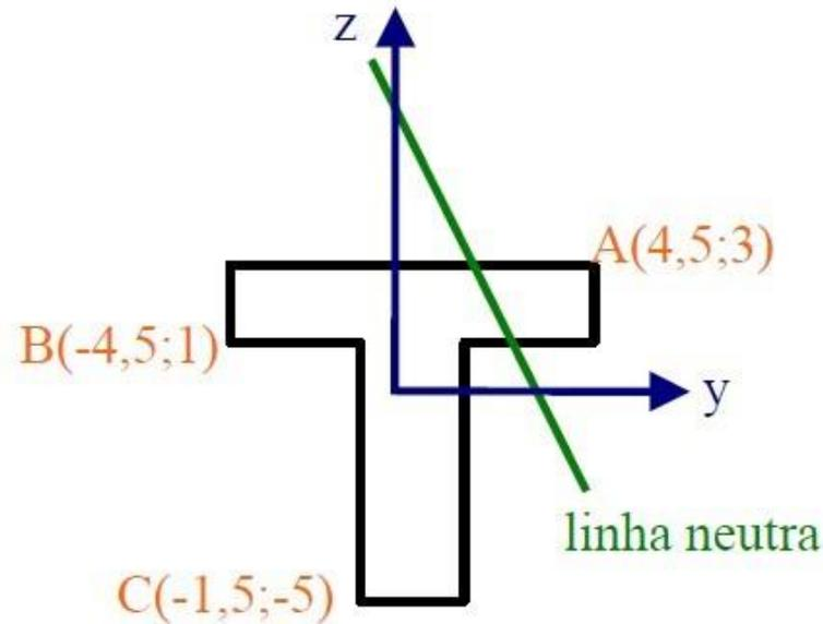
d) As tensões normais extremas são nos pontos A e (B ou C):
