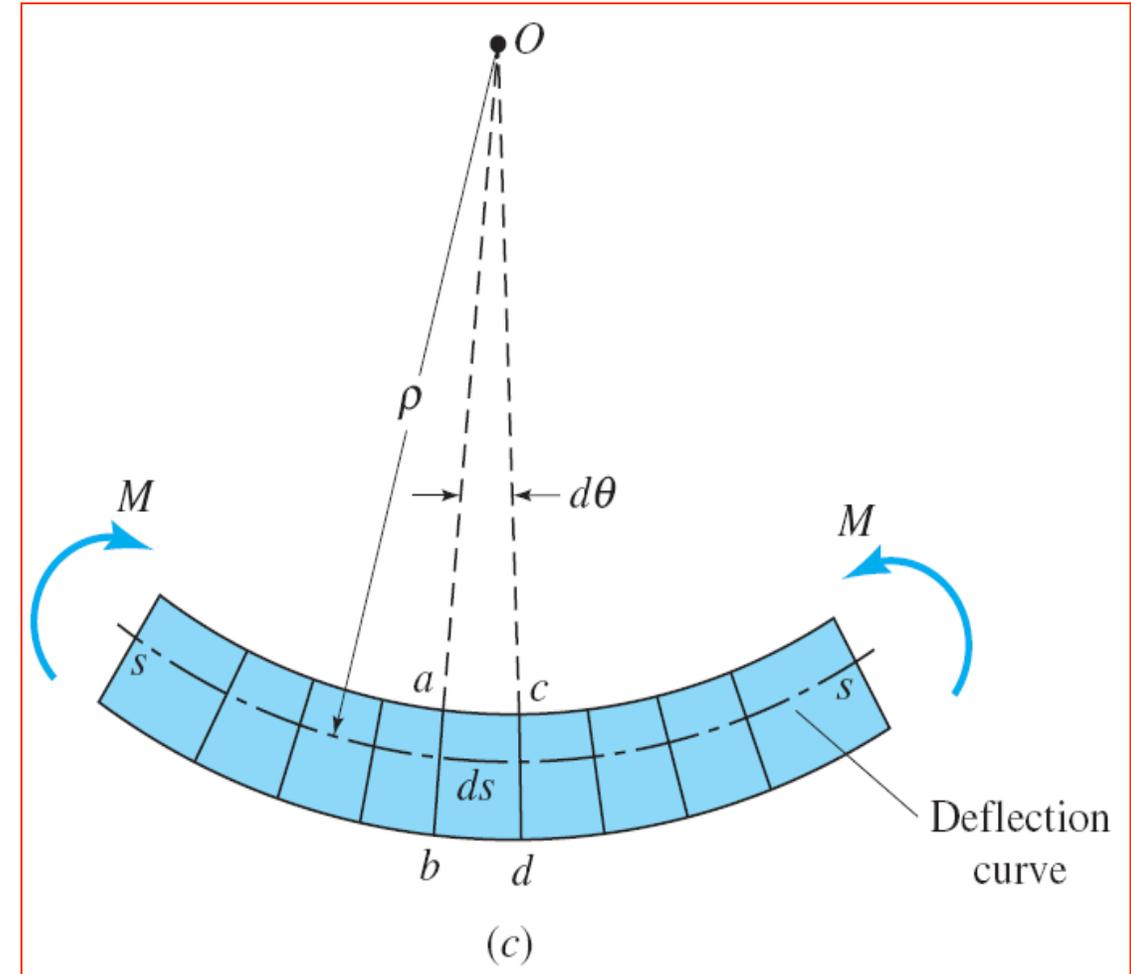
**(c) Após a deformação (flexão)**
