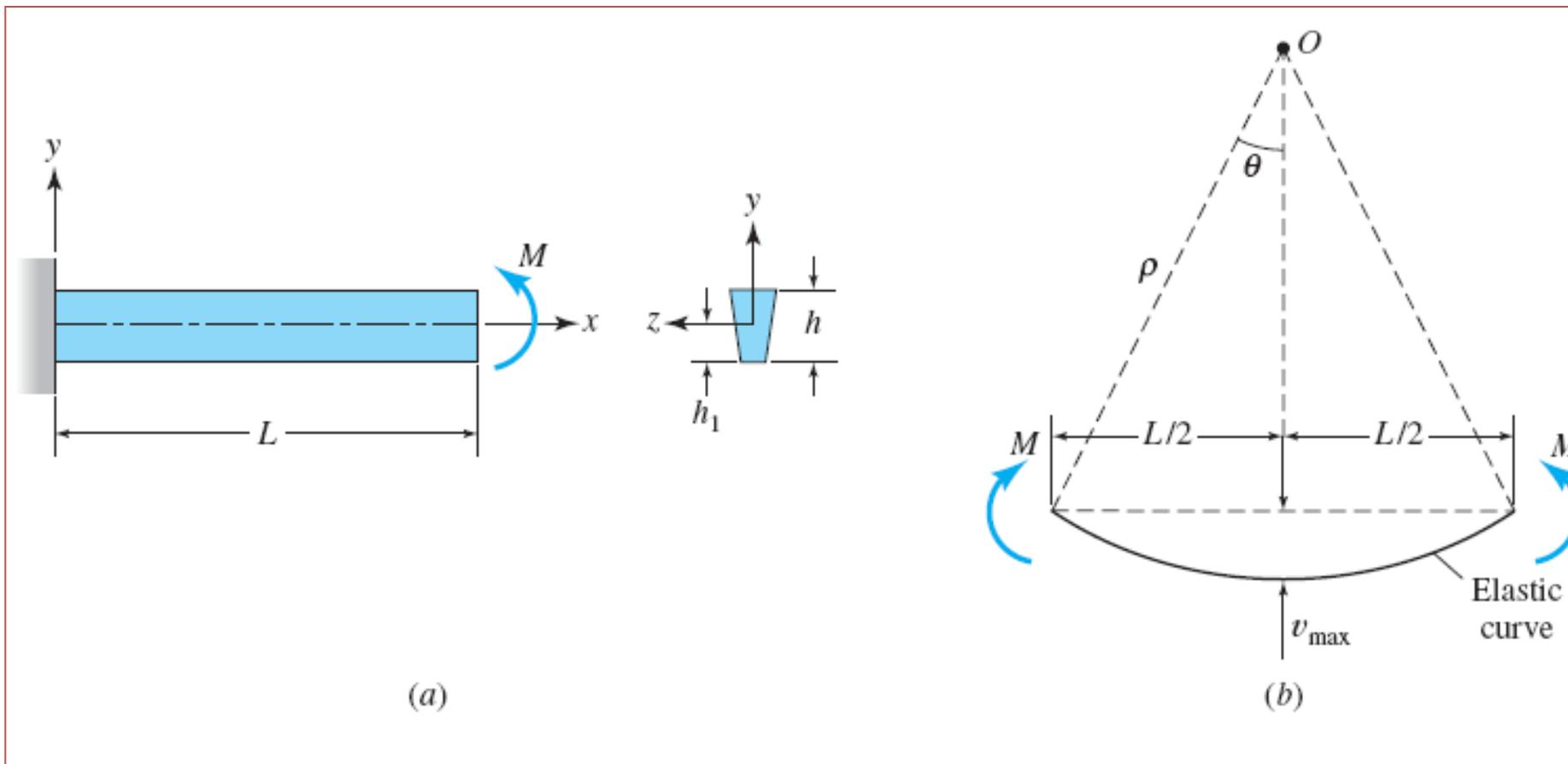
**Exercício: Um momento fletor  $M$  é aplicado à extremidade livre de uma viga engastada, de aço, com comprimento  $L=240$  cm e altura da seção transversal  $h=15$  cm. Determinar o raio de curvatura, a curvatura e o deslocamento máximo da viga, considerando que  $\varepsilon_x = 0,0012$  na superfície inferior da viga ( $y = -h_1 = -9$  cm)**
