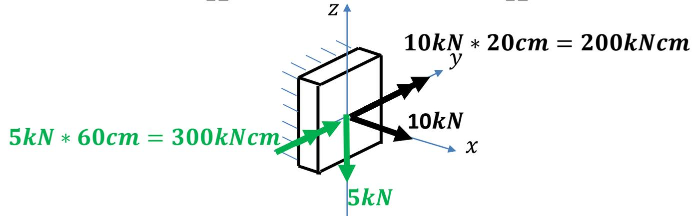
$$b) \sigma_x = \frac{N}{A} - \frac{M_z}{I_z} * y + \frac{M_y}{I_y} * z \Rightarrow \sigma_x = \frac{10}{800} - \frac{0}{26667} * y + \frac{500}{106667} * z \Rightarrow \sigma_x = 0,0125 + 0,0047 * z \left(\frac{kN}{cm^2}\right)$$
