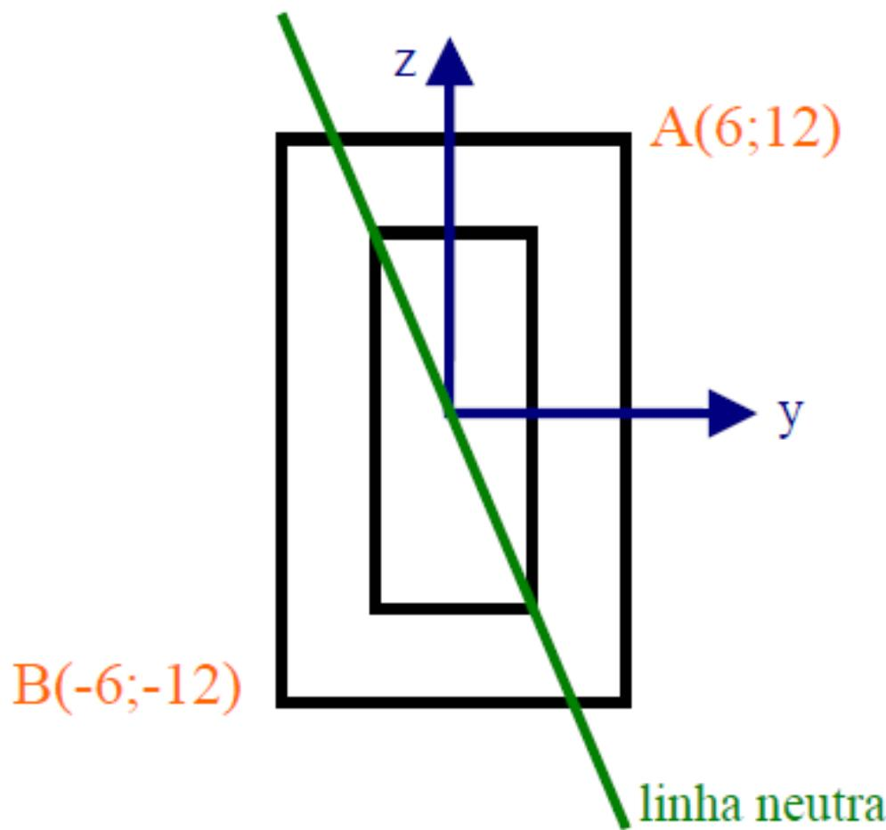
c) As tensões normais extremas são nos pontos A e B:
