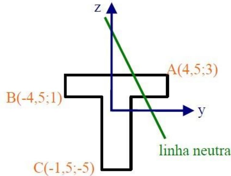
d) As tensões normais extremas são nos pontos A e (B ou C):
