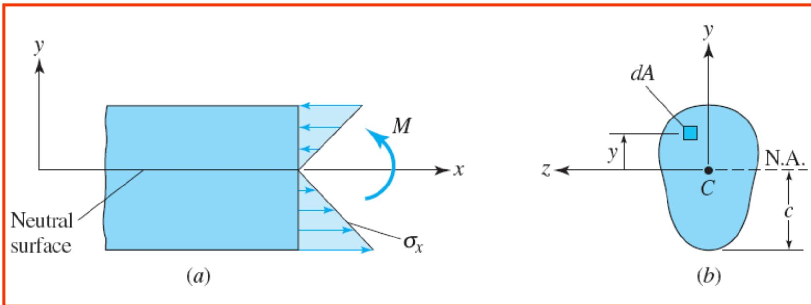
**Distribuição das tensões de flexão  $\sigma_x$  em uma viga:**
