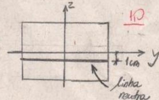
d) tensões extremas em  $z = -3 \text{ cm}$  (tensão) e  $z = 3 \text{ cm}$  (compressão):
