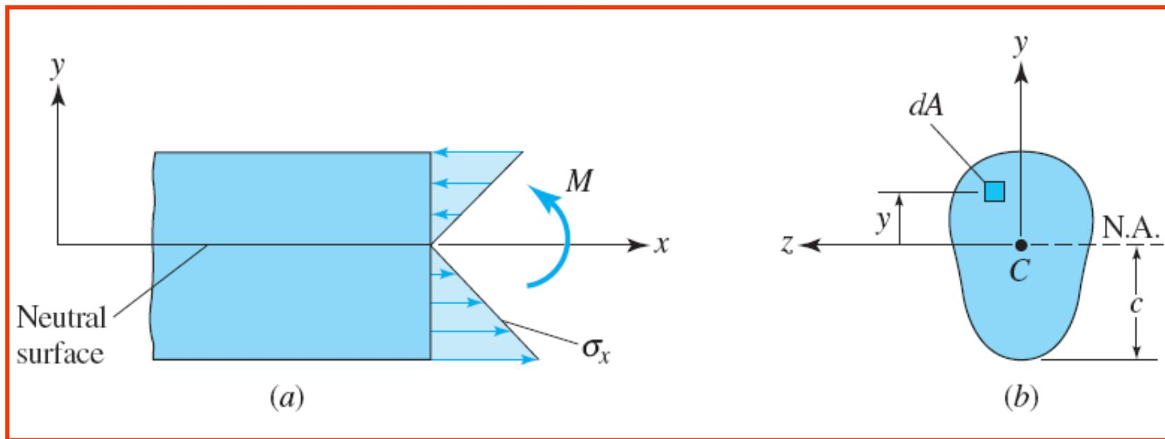
**Distribuição das tensões de flexão  $\sigma_x$  em uma viga:**
