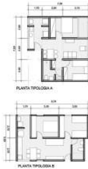
Figuras 12-14. Corte transversal e plantas das tipologias de unidades habitacionais projetadas. Elaboração própria sobre bases cedidas por Transversal
