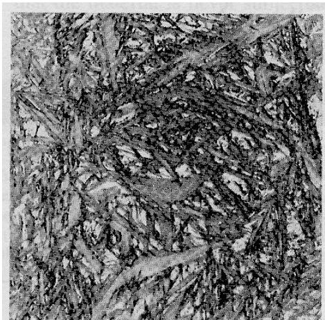
Figura 1.18 – Estrutura típica de martensita. 1000 x
