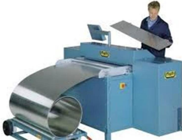
Figura 3.5 – Exemplo de corte de uma fita na largura especificada a partir de uma bobina.
