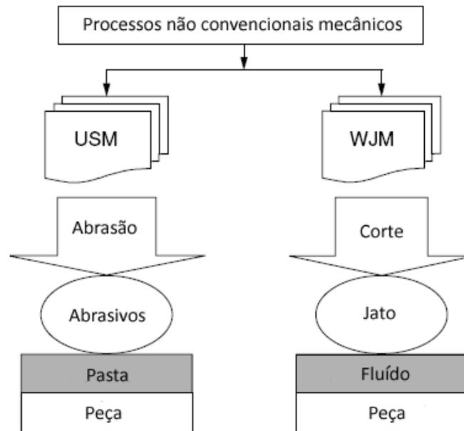
Figura 2 – Processos de usinagem não convencionais mecânicos
