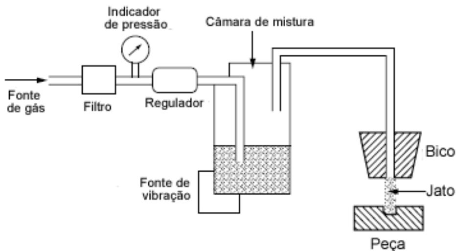
Figura 12 – Sistema de usinagem a jato abrasivo
