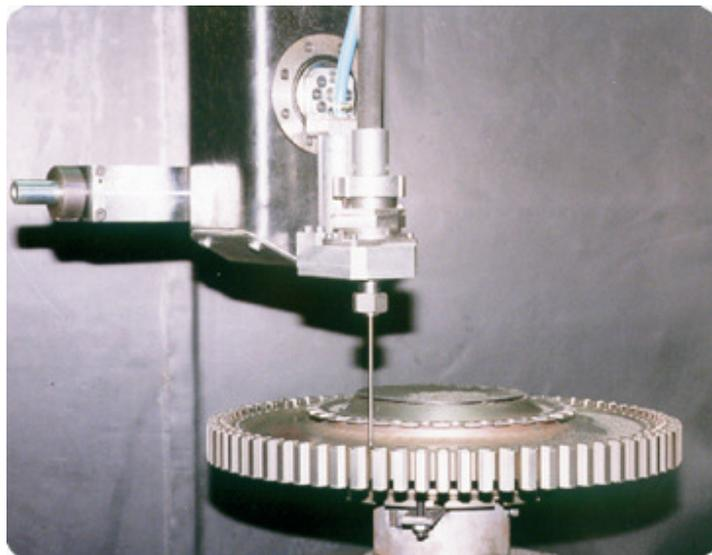
Figura 35 – Sistema de tratamento a Shot peening
