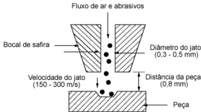
Figura 13 – Mecanismo de remoção de material na usinagem a jato abrasivo
