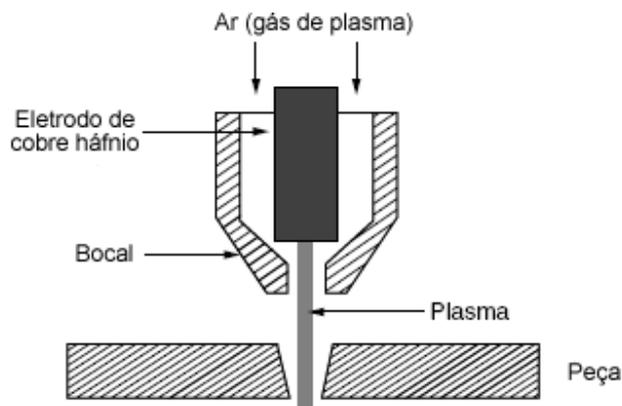
Figura 30 – Sistema de usinagem por plasma a ar
