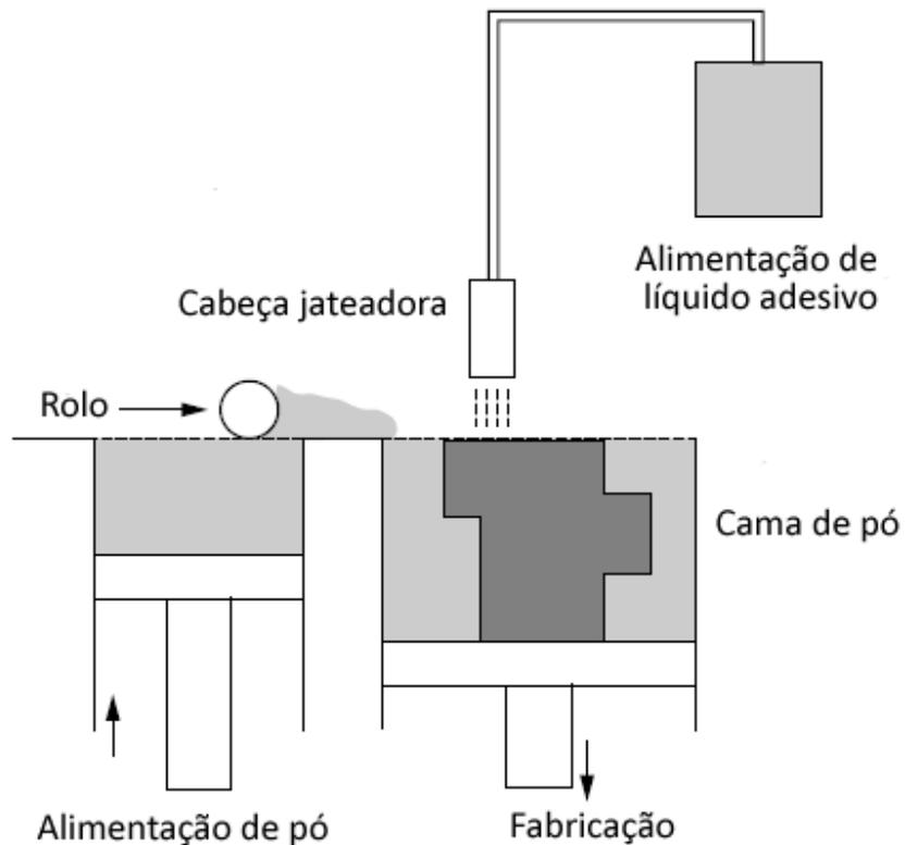
Figura 32 – Processo de impressão tridimensional
