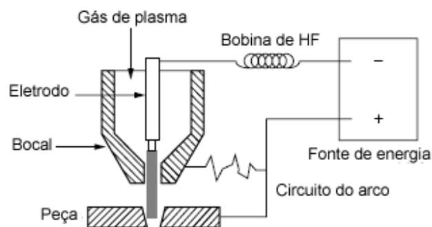
Figura 27 – Sistema de usinagem a arco de plasma
