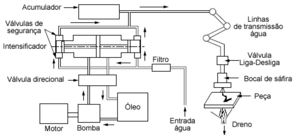
Figura 11 – Sistema de usinagem a jato de água
