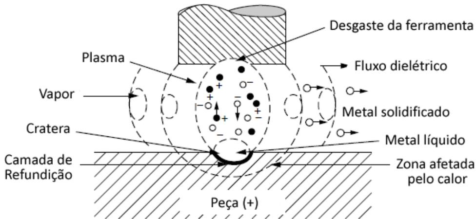
Figura 22 – Processo de eletroerosão
