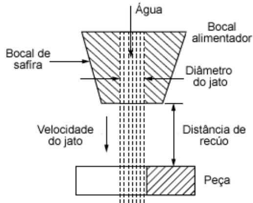
Figura 10 – Processo de usinagem a jato de água
