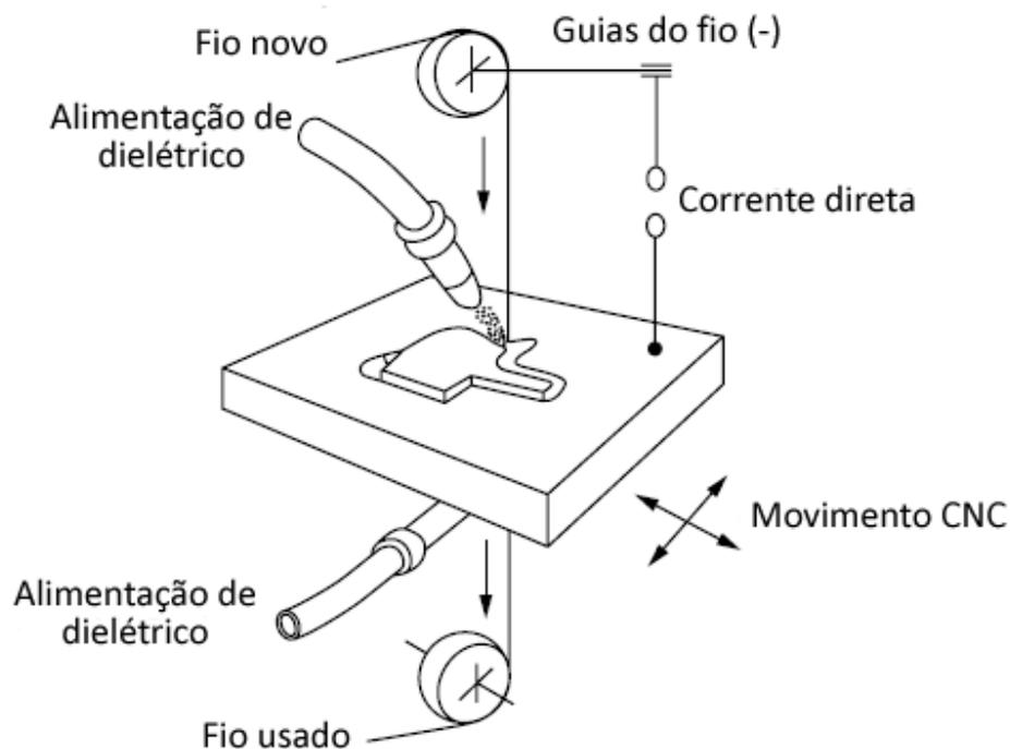
Figura 23 – Sistema de usinagem por eletroerosão a fio
