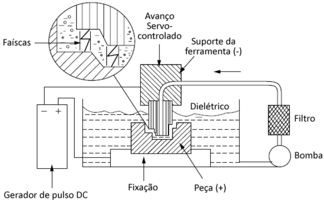
Figura 21 – Sistema usinagem por eletroerosão por penetração
