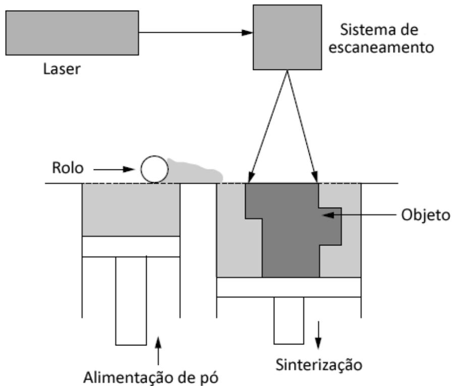
Figura 31 – Processo de sinterização seletiva a laser
