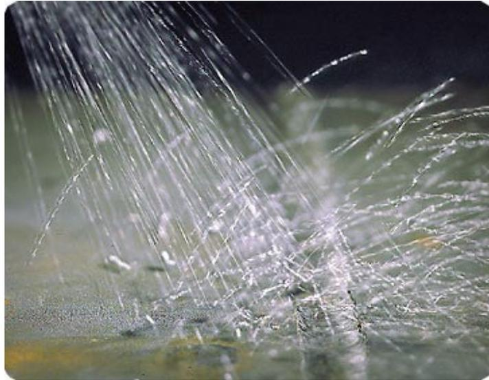
Figura 34 – Processo de Shot peening
