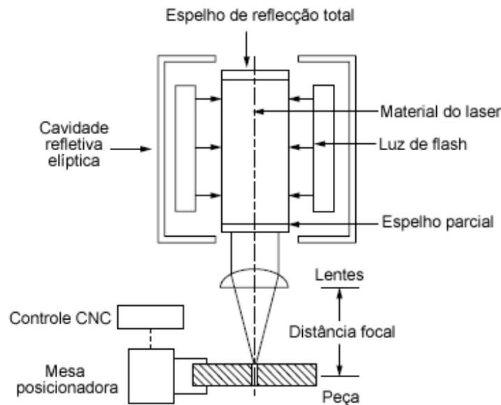
Figura 24 – Sistema de usinagem por feixe de laser
