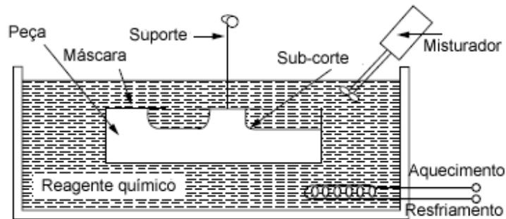
Figura 16 – Processo de usinagem química
