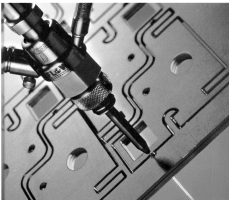
Figura 14 – Usinagem a jato de água abrasivo
