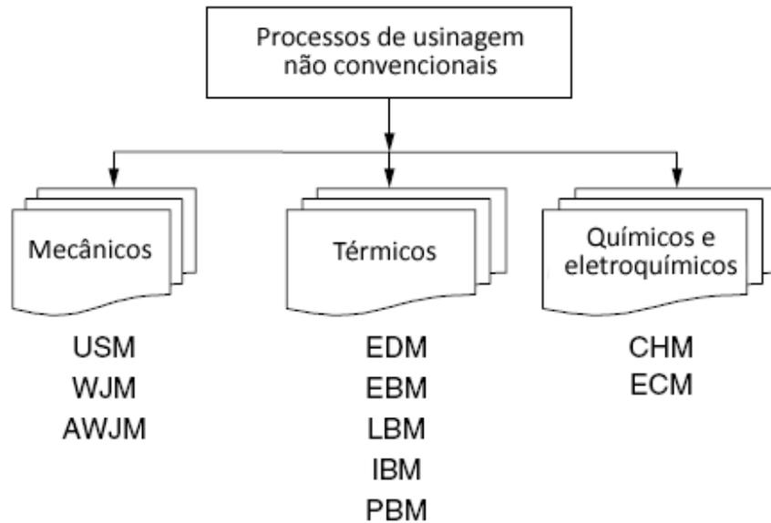
Figura 1 – Processos de usinagem não convencionais
