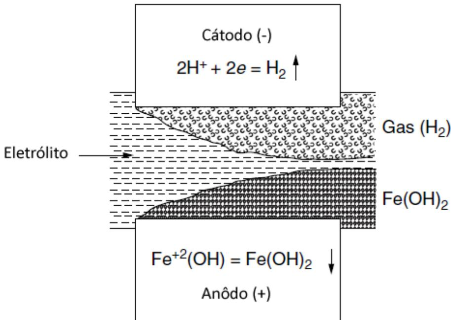
Figura 19 – Processo de usinagem eletroquímica
