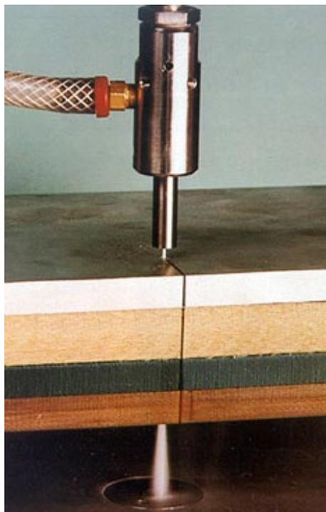
Figura 9 – Usinagem a jato de água
