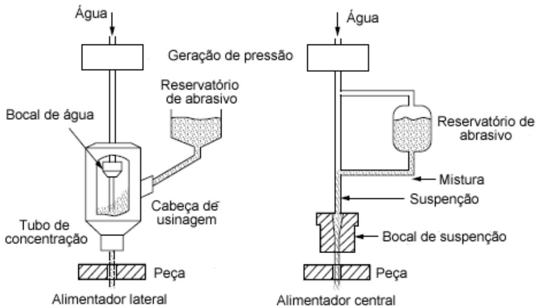
Figura 15 – Jatos de injeção e suspensão respectivamente.
