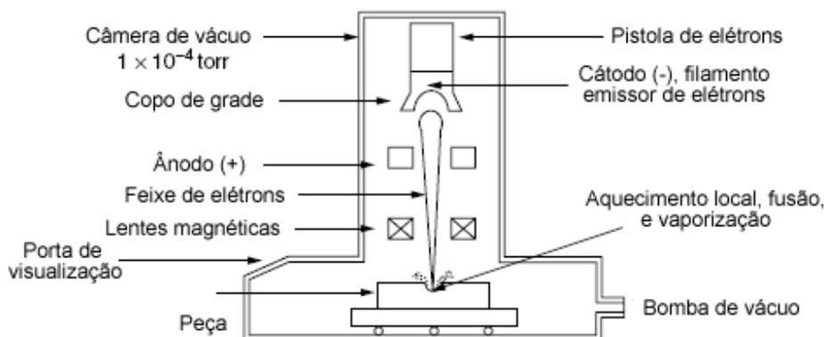
Figura 26 – Sistema de usinagem a feixe de elétrons
