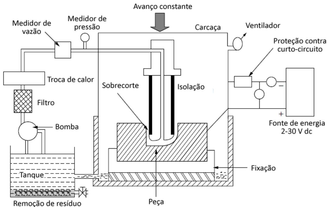
Figura 20 – Sistema de usinagem eletroquímica
