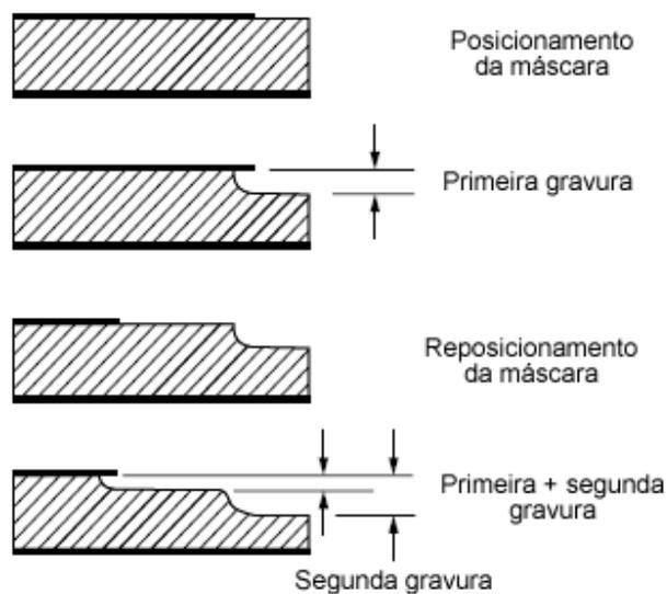
Figura 18 – Sucessivas gravuras na usinagem química
