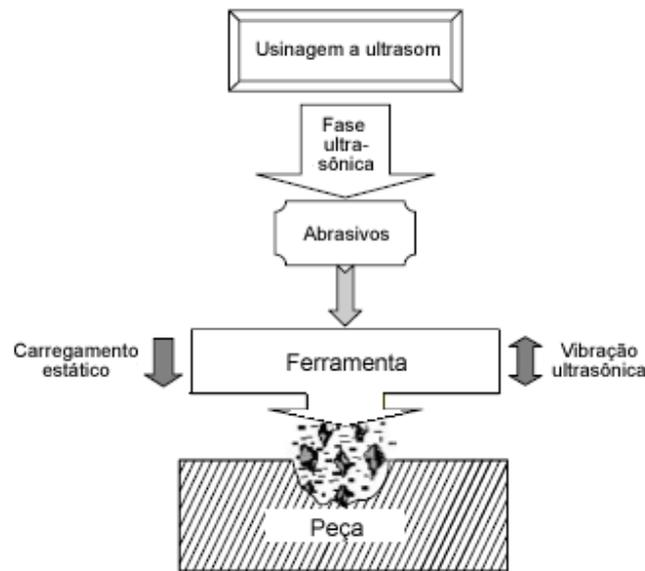
Figura 6 – Componentes de um sistema de usinagem a ultrassom
