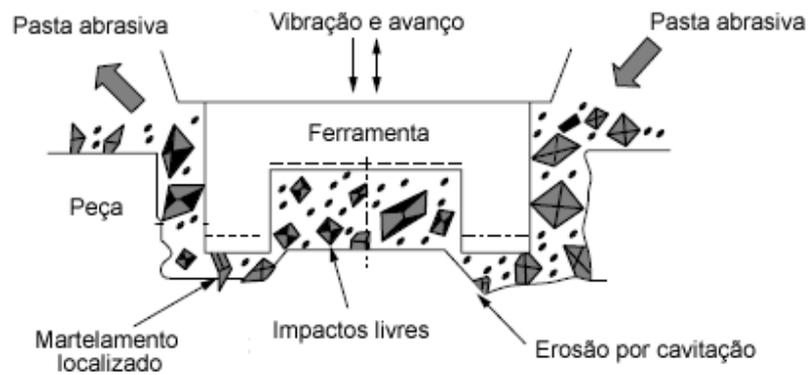
Figura 7 – Mecanismo de remoção do material na USM (adaptado de Thoe, 1995)
