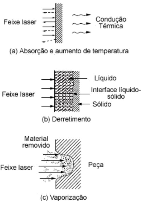
Figura 25 – Processo de usinagem por feixe de laser
