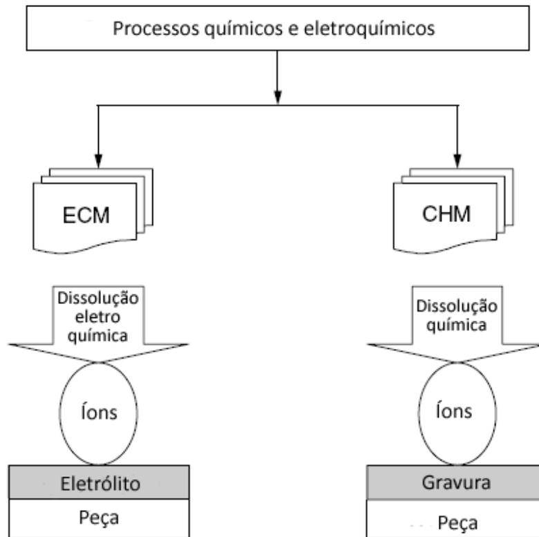
Figura 4 – Processos de usinagem não convencionais químicos e fotoquímicos
