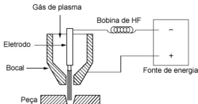
Figura 28 – Sistema de usinagem a jato de plasma
