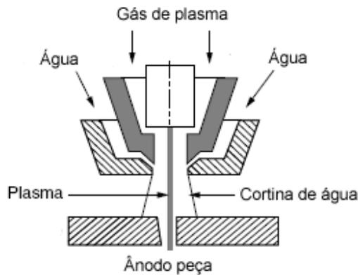
Figura 29 – Sistema de usinagem por plasma protegido por água
