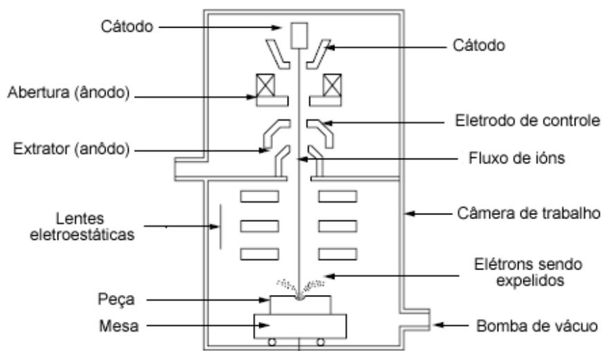
Figura 31 – Sistema de usinagem a feixe de íons
