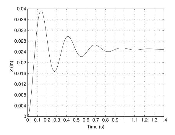
5-) O sistema de segunda ordem mostrado ao lado possui uma entrada tipo deslocamento  $x_{in}$  conforme mostrado e sua saída é o deslocamento absoluto da massa M, representado por x(t).
