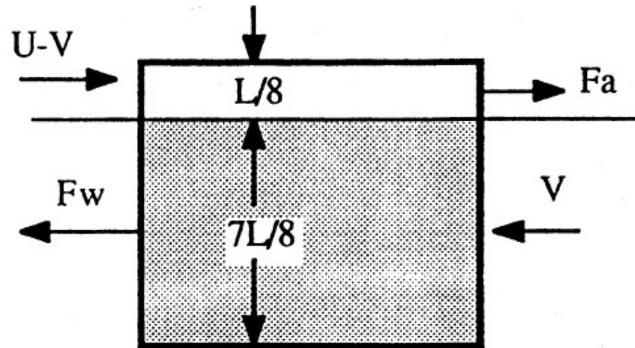
O ar empurra o iceberg exercendo uma força de arrasto  $F_a$  relacionada com uma velocidade relativa  $U-V$ . A água oferece resistência ao avanço do iceberg através de uma força de arrasto  $F_w$  relacionada com uma velocidade relativa  $V$ . Como o iceberg tem velocidade constante, as duas forças se equilibram. Assim:
