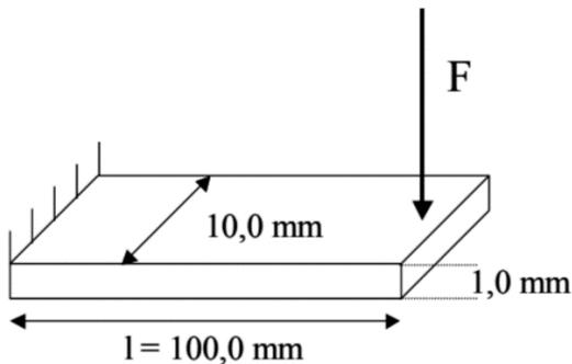
a) Calcule o valor do coeficiente de elasticidade  $k$  para o caso de uma força aplicada em umas das extremidades da régua como mostrado na figura. Não é necessário fazer os cálculos com erros.
