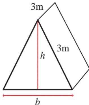
É importante notar que o valor de  $b$  depende de  $h$ . De fato, usando o Teorema de Pitágoras, vemos que  $3^2 = h^2 + (b/2)^2$ , ou ainda,  $b = 2\sqrt{9 - h^2}$ . Assim, podemos construir uma função  $V(h)$  que fornece, para cada valor de  $h$ , o volume da barraca.
