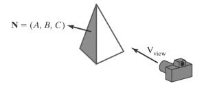
Em um sistema de coordenadas com direção de visualização ao longo do eixo -z, uma face de um polígono é traseira se a terceira componente de N é tal que C < 0.
