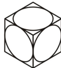
Para a construção da perspectiva do círculo é necessária a construção de uma das faces do cubo isométrico, os quais possuem arestas do tamanho do diâmetro do círculo que se vai desenhar
