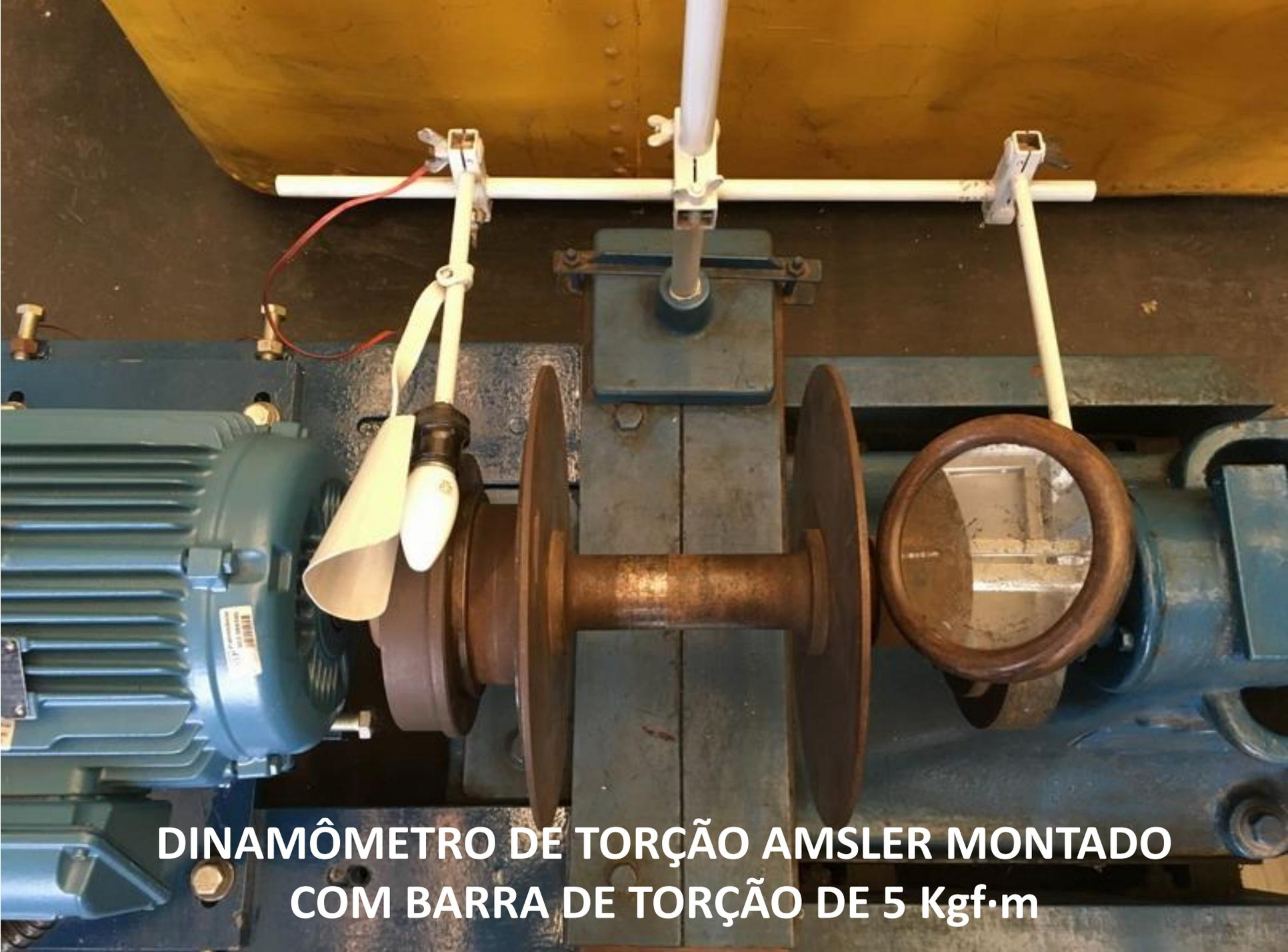
**DINAMÔMETRO DE TORÇÃO AMSLER MONTADO
