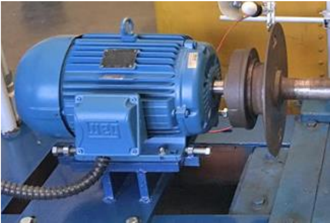
Fig. 3.3 - Motor WEG, 10 cv, de velocidade variável, por inversor de frequência.
