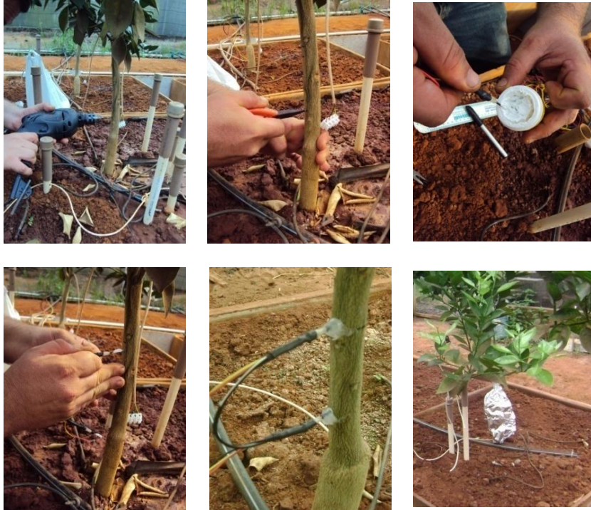
Figura 8 - Instalação das sondas de dissipação térmica
