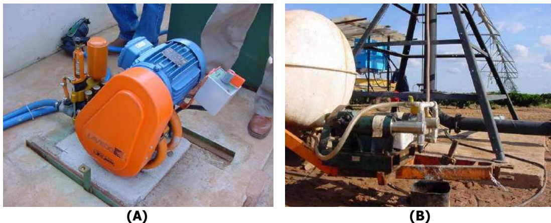
Figura 10. Sistema de fertirrigação utilizando bomba injetora de pistão (BASTOS, 2009).
