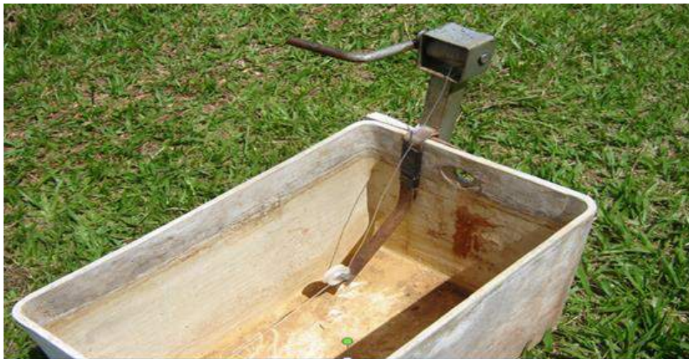
Figura 5. Detalhe da roldana e do esticador, adaptado com uma manopla para facilitar a operação, instalados na caixa de recepção.
