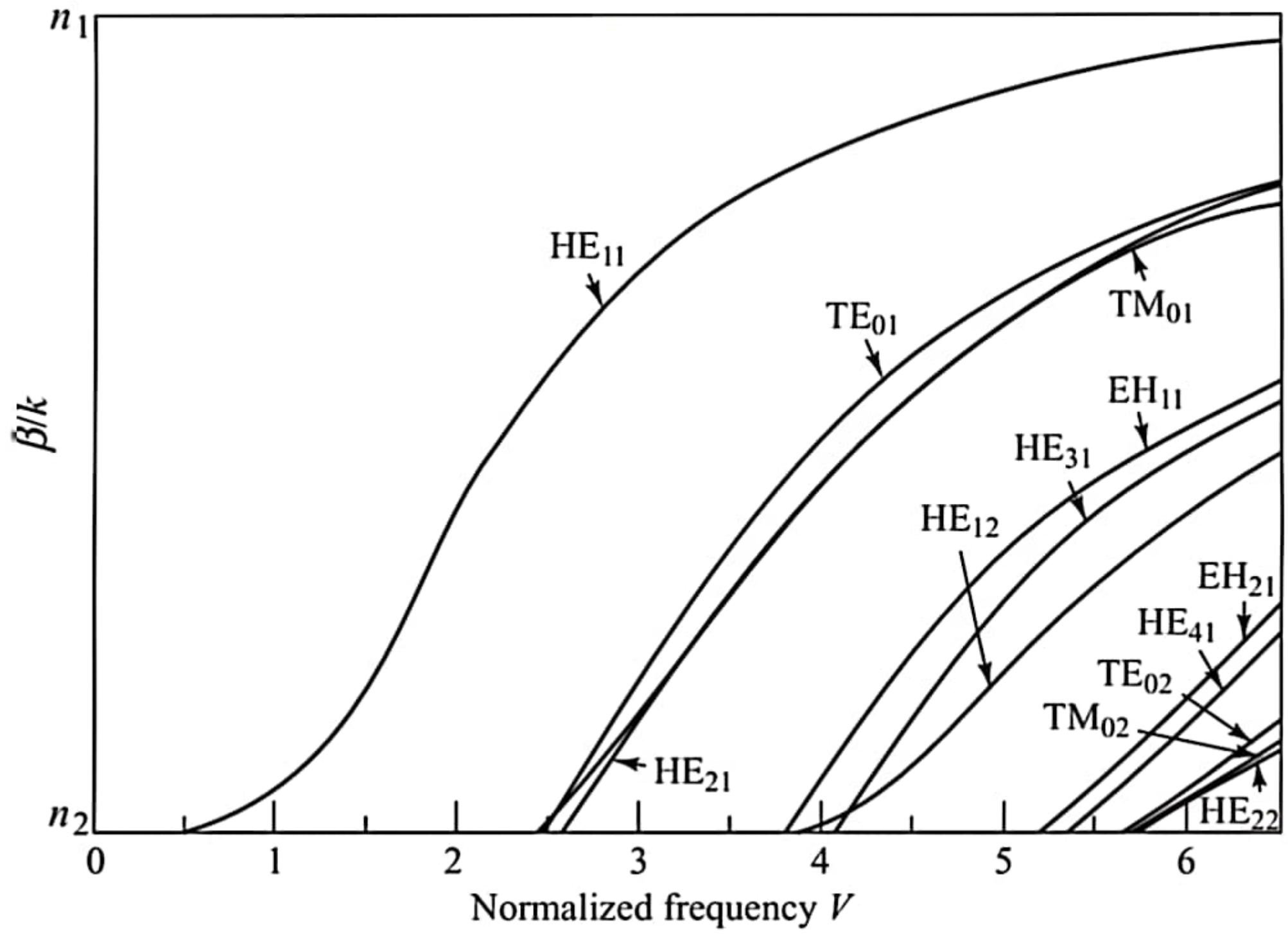
Logo, a condição de um único modo existente é determinada para o valor de  $V$  em que  $TE_{01}$  e  $TM_{01}$   $\textcircled{1}$  entram em corte. Utilizando o polinômio característico (III), é possível encontrar para  $m=0$ :
