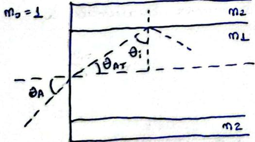
Ainda na discussão sobre RIT, considere que um raio incide na abertura da fibra com ângulo de admissão  $\theta_A$ , o raio de um meio com índice  $n_0 = 1$  (AR, VÁCUO). Esse raio sofre refração na abertura da fibra e passa a se propagar dentro do núcleo. Contudo, para que haja um funcionamento correcto do guia, o ângulo de incidência  $\theta_i$  desse raio com a interface núcleo/casca deve ser maior que o ângulo crítico  $\theta_c$ , como dito, para ocorrência da reflexão total.
