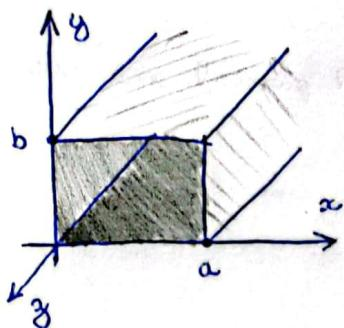
O guia de onda retangular compõe o conjunto dos guias metálicos, como é o caso do guia de placas paralelas. Seu funcionamento é semelhante aos demais guias: confinamento e condução da energia eletromagnética de um ponto para outro por meio de RIT em placas metálicas.
