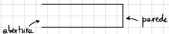
(a) parede  $\leftrightarrow$  deslocamento  $u(x_{\text{parede}}, t) = 0$
