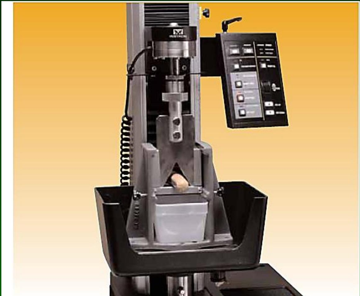
Dispositivo de cisalhamento W-B com estrutura de suporte e bandeja coletora
