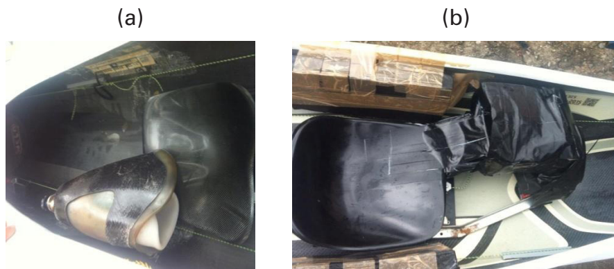
Figura 6 - Equipamentos utilizados por atletas VL3/KL3. Legenda (a): adaptação para fixação do coto; Legenda (b): banco sem encosto para caiaque, limitadores laterais e de membros inferiores
