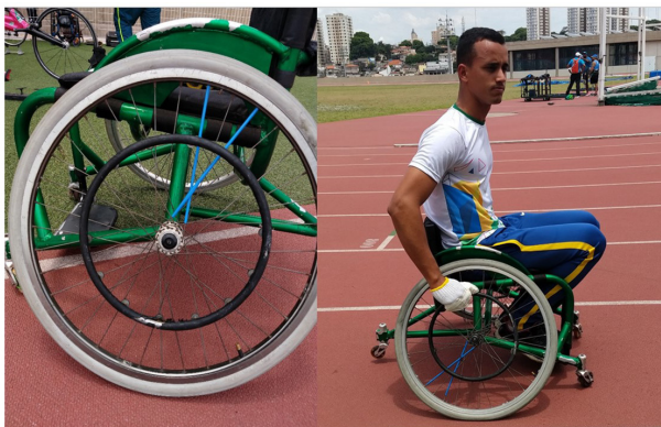
Figura 23– Adaptação do aro de propulsão de paratletismo na cadeira de basquete para a iniciação esportiva
