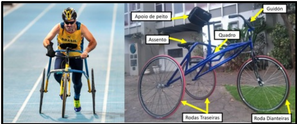
Figura 25 – Equipamento de Racing Running com especificações e atleta competindo ( petra )
