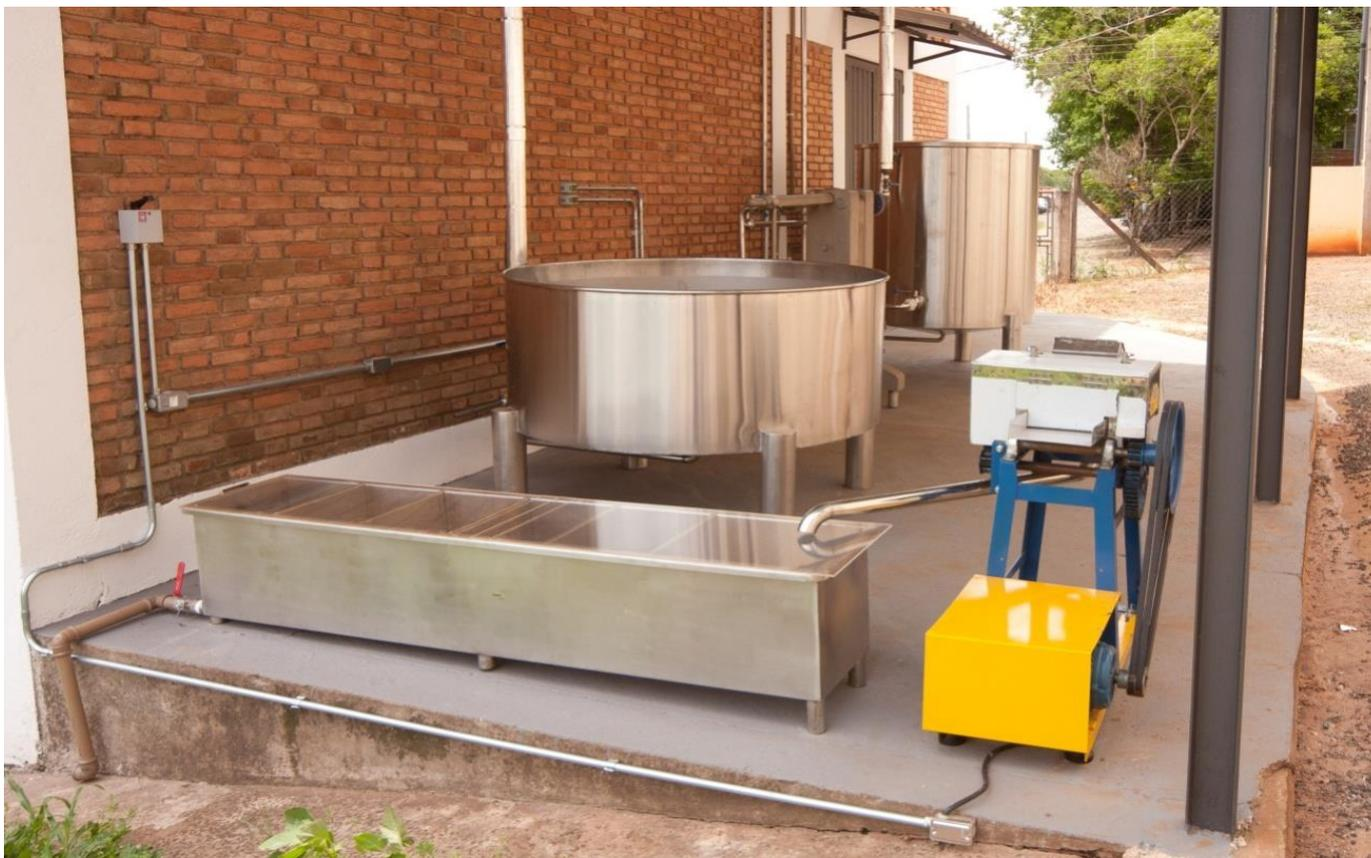
**Preparo do caldo (moenda, decantador 1, dorna diluidora de caldo, trocador de calor e decantador 2)**
