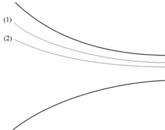
Isso ajuda a explicar porque, em túneis de vento, antes da seção de testes temos uma contração. Ela ajuda a termos um perfil de velocidades uniforme na seção de testes.
