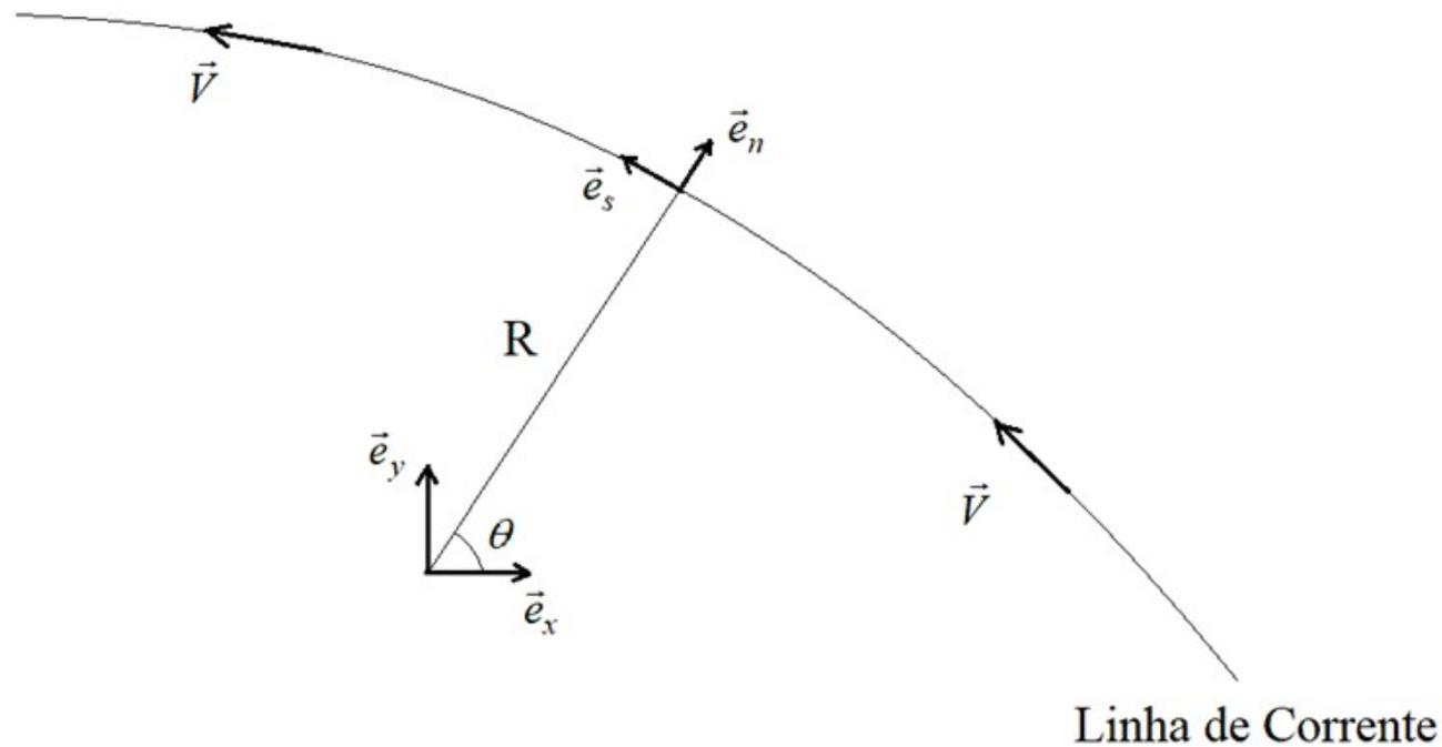
Um sistema de coordenadas orientado de acordo com o vetor da velocidade é chamado de Sistema Intrínseco de Coordenadas. Dado o raio de curvatura em um ponto da linha de corrente, podemos construir os versores  $\vec{e}_n$  e  $\vec{e}_s$  de uma forma similar à usada para construir um sistema cilíndrico de coordenadas, como visto em aula. Temos que:
