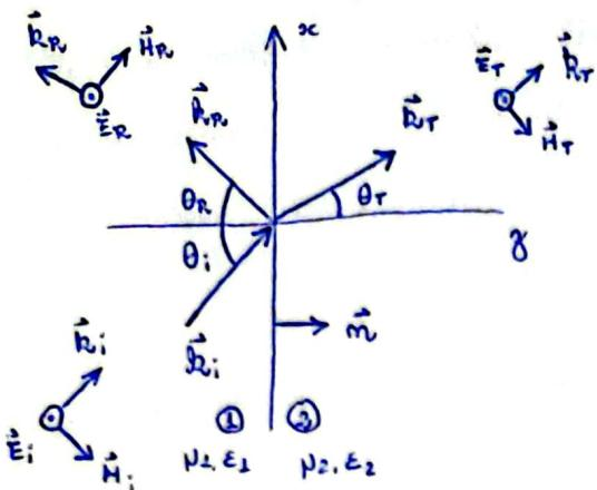
Considerando dois meios isotrópicos 1 ( $\mu_1, \epsilon_1$ ) e 2 ( $\mu_2, \epsilon_2$ ) com uma interface ( $z=0$ ), onde  $\hat{n}$  é o vetor normal à interface, seja a situação especial com campo elétrico incidente  $\vec{E}_i = E_0 e^{-j(k_{ix}x + k_{iz}z)} \hat{y}$ , um que as ondas propagam-se, situadas no plano  $xz$ , tem-se:
