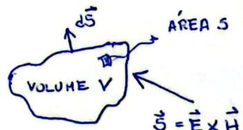
$$\begin{pmatrix} \text{POTÊNCIA} \\ \text{ENTRANDO NO} \\ \text{VOLUME } V \end{pmatrix} = \begin{pmatrix} \text{TAXA DE ACRESCIMO} \\ \text{DA ENERGIA MAGNÉTICA ARMAZENADA} \\ \text{EM } V \end{pmatrix} + \begin{pmatrix} \text{TAXA DE ACRESCIMO DA} \\ \text{ENERGIA ELÉTRICA AR-} \\ \text{MAZENADA EM } V \end{pmatrix} + \begin{pmatrix} \text{POTÊNCIA} \\ \text{DISSIPADA} \\ \text{NO} \\ \text{VOLUME } V \end{pmatrix}$$
