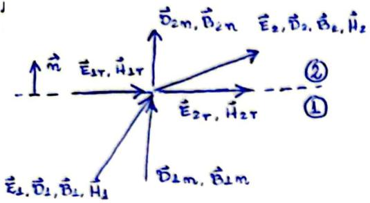
OBS.: A corrente superficial só existe na superfície de condutor perfeito. Em materiais com condutividade finita, a corrente flui por uma camada próxima da superfície  $\Rightarrow K_s = 0$
