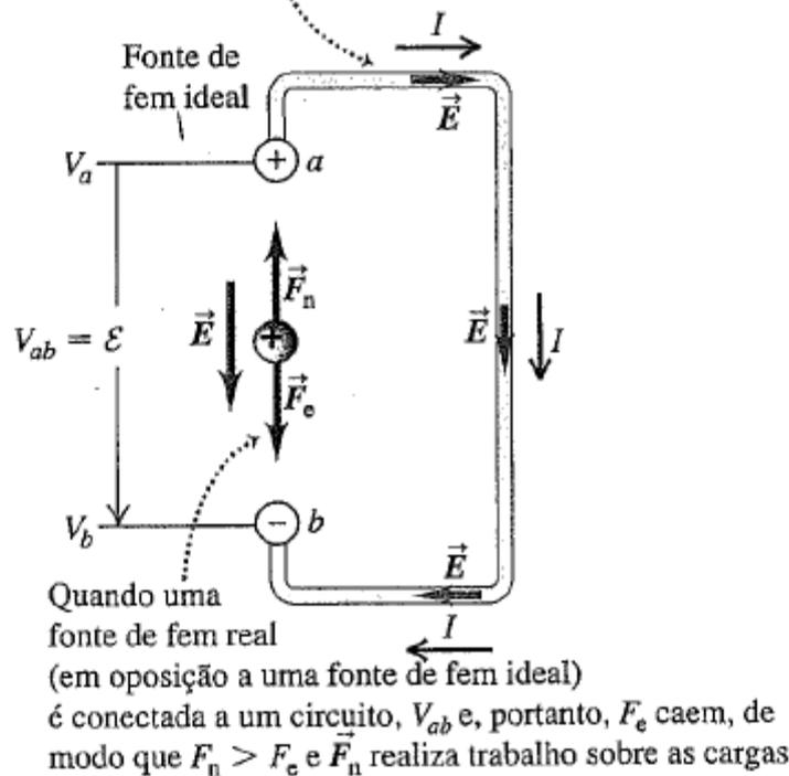
**Figura 25.15** Diagrama esquemático de uma fonte de fem ideal em um circuito completo. A força do campo elétrico  $\vec{F}_e = q\vec{E}$  e a força não-eletrostática  $\vec{F}_n$  são indicadas para uma carga positiva  $q$ . A corrente flui de  $a$  para  $b$  no circuito externo e de  $b$  para  $a$  no interior da fonte.
