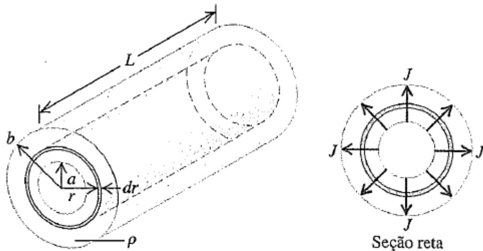
**Figura 25.11** Cálculo da resistência para um escoamento radial.
