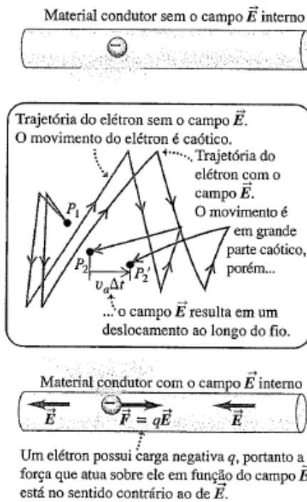
**Figura 25.1** Quando não existe nenhum campo elétrico no interior de um material condutor, um elétron pode se mover caoticamente do ponto  $P_1$  até  $P_2$  depois de um intervalo de tempo  $\Delta t$ . Quando um campo elétrico  $\vec{E}$  está presente, a força elétrica  $\vec{F} = q\vec{E}$  produz uma pequena velocidade de arraste (muito exagerada na figura), que conduz o elétron ao ponto  $P'_2$  por uma distância  $v_d \Delta t$  de  $P_2$  no sentido da força.
