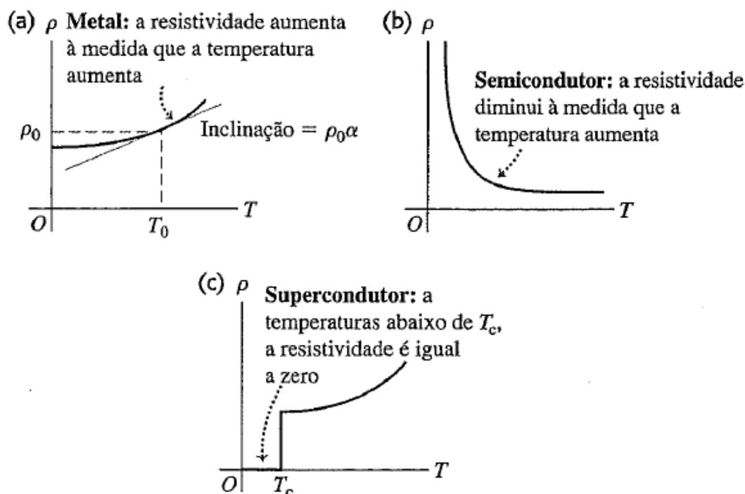
**Figura 25.6** Variação da resistividade  $\rho$  em função da temperatura absoluta  $T$  para (a) um metal normal, (b) um semicondutor e (c) um supercondutor. Em (a), a aproximação linear de  $\rho$  em função de  $T$  é indicada por um segmento de linha reta; a aproximação concorda com o valor da função para  $T = T_0$  quando  $\rho = \rho_0$ .
