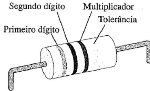
**Figura 25.9** Este resistor possui uma resistência de  $5,7 \text{ k}\Omega$ , com uma precisão (tolerância) de  $\pm 10\%$ .
