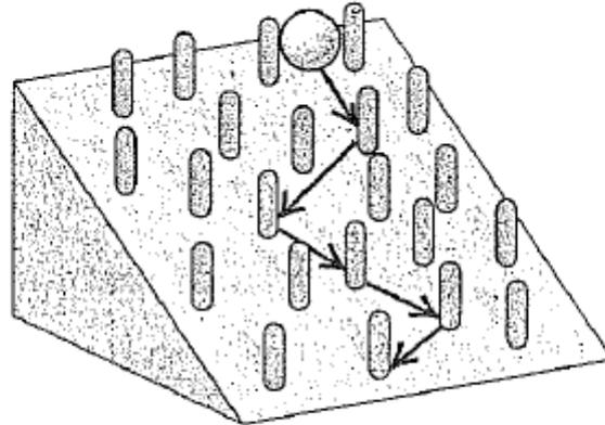
**Figura 25.28** O movimento de uma bola rolando para baixo de um plano inclinado e mudando de direção em virtude das colisões com os obstáculos fornece uma analogia mecânica com o movimento dos elétrons em um condutor metálico quando existe um campo elétrico aplicado.
