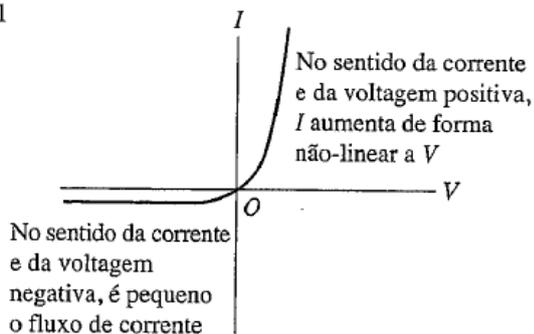
**Figura 25.10** Relações corrente–voltagem para dois dispositivos. Somente para um resistor que obedece à lei de Ohm, como em (a), é que  $I$  é proporcional a  $V$ .
