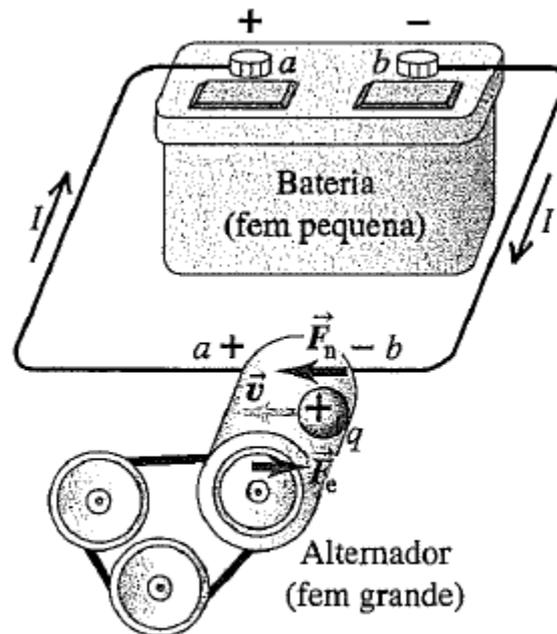
**Figura 25.24** Quando duas fontes são conectadas entre si em um único circuito, a fonte que possui fem mais elevada fornece energia para a outra.
