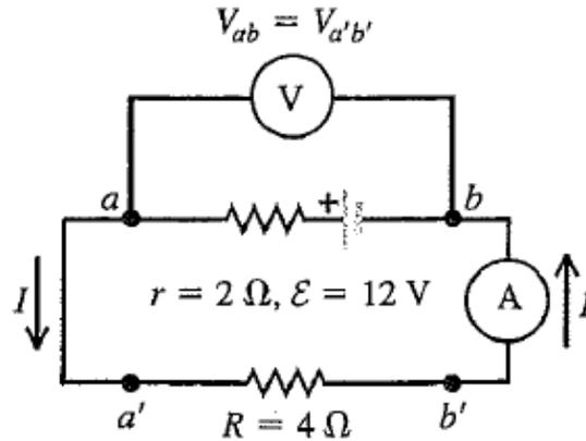
**Figura 25.18** Uma fonte de fem em um circuito completo.
