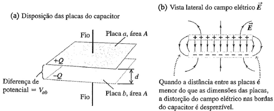
**Figura 24.2** Um capacitor de placas paralelas carregado.
