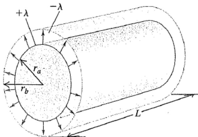
**Figura 24.6** Um capacitor cilíndrico longo. A densidade de carga linear  $\lambda$  é considerada positiva nesta figura. O módulo da carga em um comprimento  $L$  de ambos os cilindros é igual a  $\lambda L$ .
