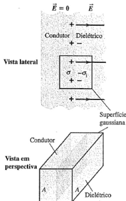
**Figura 24.23** A lei de Gauss na presença de um dielétrico. Esta figura mostra uma ampliação da placa esquerda do capacitor indicado na Figura 24.15b. A superfície gaussiana é uma caixa retangular que fica metade no condutor e metade no dielétrico.
