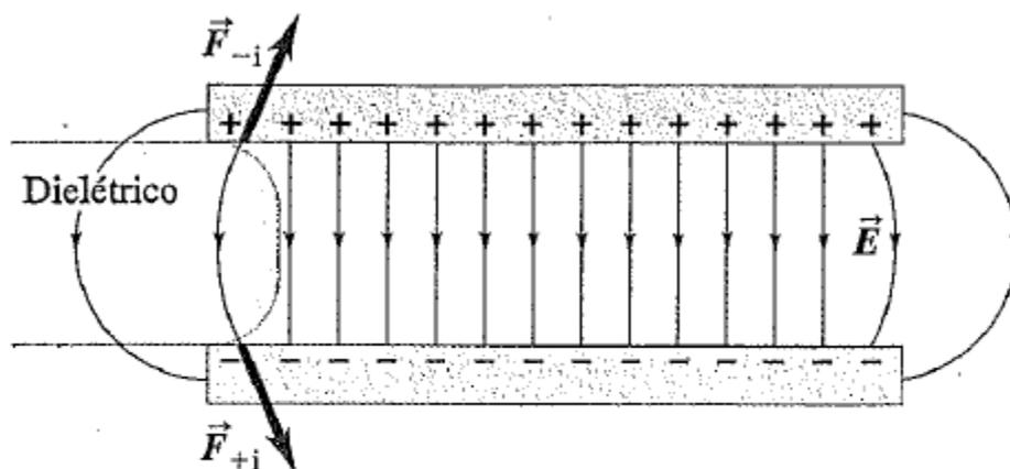
**Figura 24.16** A deformação do campo elétrico nas bordas do capacitor produz forças  $\vec{F}_{-i}$  e  $\vec{F}_{+i}$  sobre as cargas induzidas negativa e positiva na superfície de um dielétrico, atraindo o dielétrico para o capacitor.
