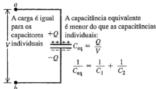
Figura 24.8 Ligação em série de dois capacitores.
