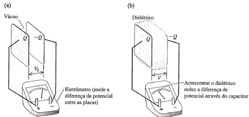
**Figura 24.14** Efeito de um dielétrico colocado entre as placas de um capacitor com placas paralelas. (a) Para uma dada carga, a diferença de potencial é  $V_0$ . (b) Para a mesma carga, porém com um dielétrico colocado entre as placas, a diferença de potencial  $V$  é menor do que  $V_0$ .
