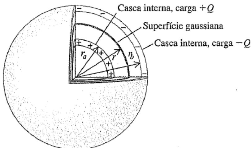
**Figura 24.5** Um capacitor esférico.
