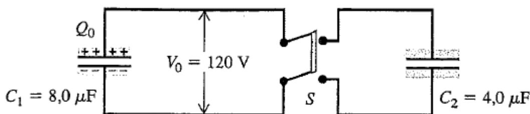
**Figura 24.12** Quando a chave  $S$  está fechada, o capacitor carregado  $C_1$  fica conectado ao capacitor descarregado  $C_2$ . A parte central da chave possui uma alça isolante; as cargas só podem ser transferidas entre os dois terminais superiores e entre os dois terminais inferiores dos capacitores.
