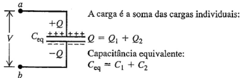
**Figura 24.9** Ligação paralela entre dois capacitores.
