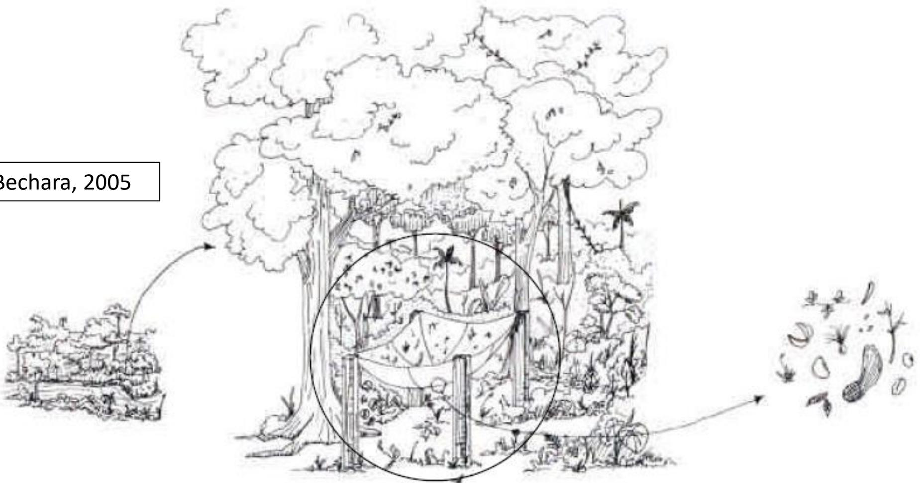
Figura 8 - Coletor de sementes usado para captura de chuva de sementes em áreas naturais. Desenho extraído de Bechara et al. (2005)
