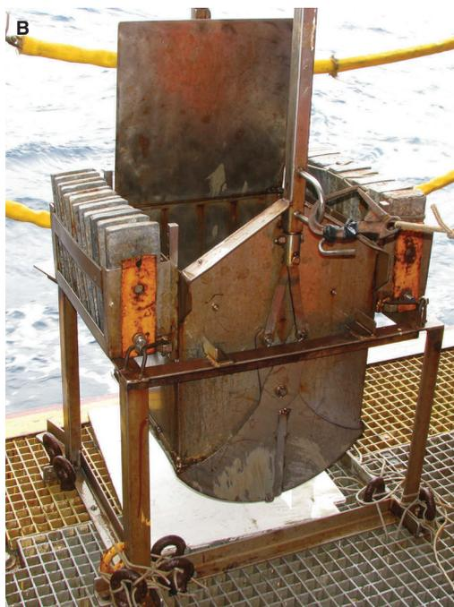
**FIGURA 8.** Amostradores de fundo do tipo van Veen utilizados nas coletas de sedimento da plataforma continental (A). *Box-corer* utilizado nas coletas de sedimento do talude e cânions (B).
