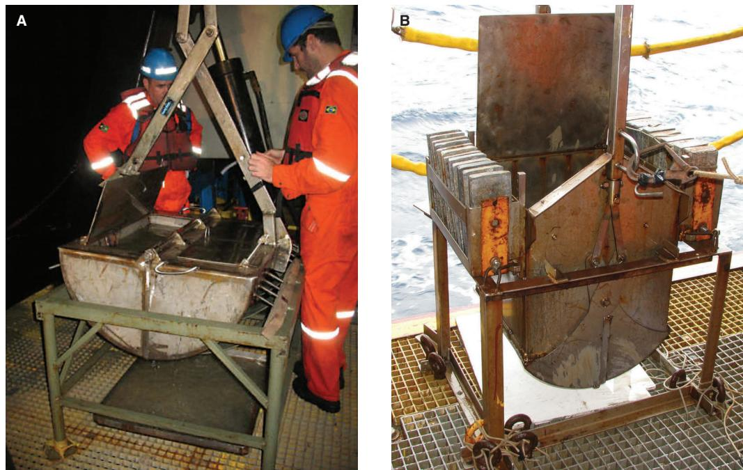
**FIGURA 8.** Amostradores de fundo do tipo van Veen utilizados nas coletas de sedimento da plataforma continental (A). Box-corer utilizado nas coletas de sedimento do talude e cânions (B).
