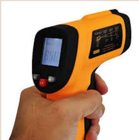
**LASER:** Aferição mais exata que o termômetro haste, pois apesar de aferir somente a superfície do alimento, a área de contato entre a mira infravermelha e o alimento é regular.
