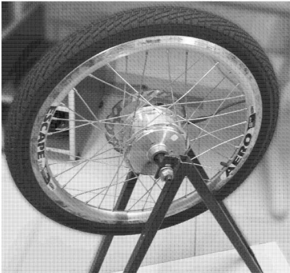
Figura 3.9: Motor BLDC no eixo de tração de uma roda de bicicleta elétrica a ser usado nas aulas de laboratório.
