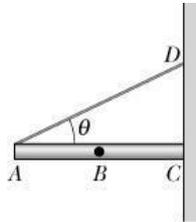
21. Na figura, suponha que o comprimento  $L$  da barra uniforme seja 3,00 m e que seu peso seja 200 N. Seja  $P = 300\text{ N}$  o peso do bloco e o ângulo  $\theta = 30,0^\circ$ . O fio pode suportar uma tensão máxima de 500 N. (a) Qual é a maior distância  $x$  possível antes que o fio se arrebente? Com o bloco posicionado neste valor máximo de  $x$ , quais são: as componentes (b) horizontal e (c) vertical da força da dobradiça sobre a barra no ponto A?
