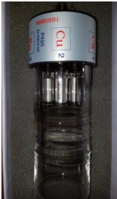
Figura 5.8. Lâmpada de cátodo oco. Perfil da montagem básica e esquema de funcionamento do cátodo.
