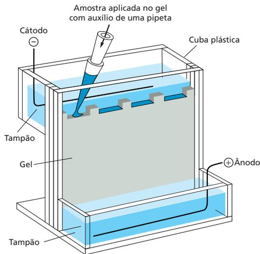
Quando um campo elétrico é aplicado a uma solução contendo moléculas proteicas, o tamanho e a carga das moléculas influenciam a direção para onde migram e a que velocidade. Essa é a base da técnica de **eletroforese**.
