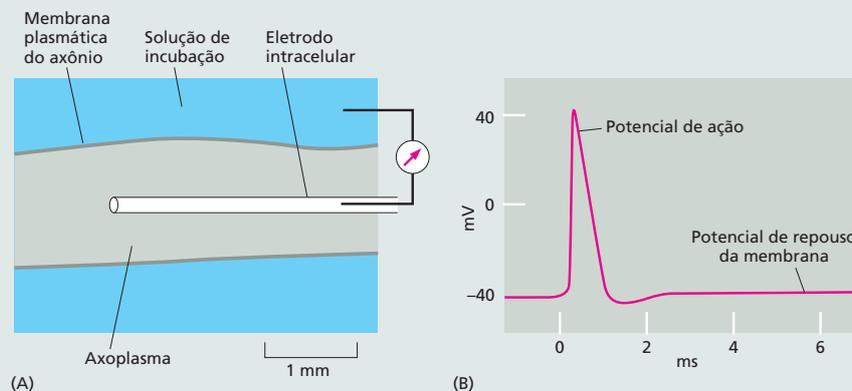
**Figura 12-32** Os cientistas podem estudar a excitabilidade das células nervosas utilizando um axônio isolado de lula. Um eletrodo pode ser inserido dentro do citoplasma (axoplasma) de um axônio gigante de lula (A) para medir o potencial de repouso da membrana e monitorar os potenciais de ação induzidos quando o axônio é eletricamente estimulado (B).
