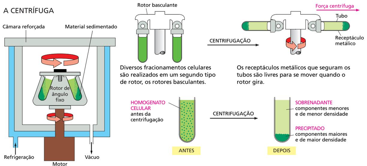
A **centrifugação** é o procedimento mais utilizado para a separação do homogenato em diferentes partes, ou frações. O homogenato é colocado em tubos de ensaio e centrifugado em altas velocidades em centrífuga ou ultracentrífuga. Ultracentrífugas atuais chegam a velocidades acima de 100.000 rpm e produzem forças de até 600.000 vezes a força da gravidade.
