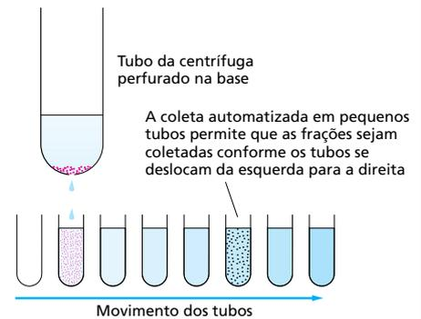
Após um tempo de centrifugação apropriado, as bandas podem ser coletadas; a forma mais simples de coletar cada banda é perfurando o tubo plástico centrifugado e coletando os resíduos do fundo, como mostrado aqui.
