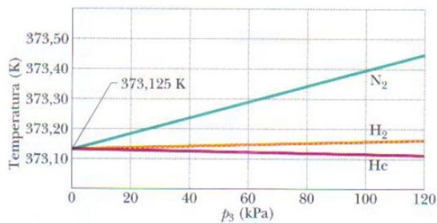
Figura 0.5: Gráfico das temperaturas medidas por um termômetro de gás a volume constante, com o bulbo imerso em água fervente [1].
