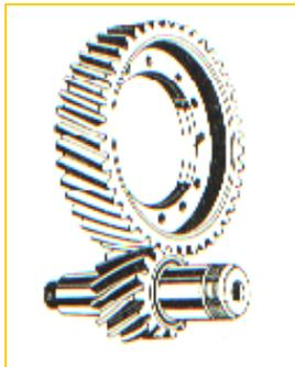
**d) engrenagem cilíndrica com dentes helicoidais**
