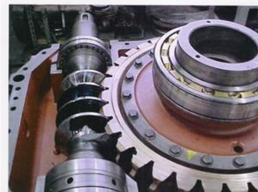
Redutor tipo “coroa-parafuso sem fim”. http://www.fresadorasantana.com.br . (acesso: 27/02/2016)
