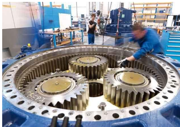
Conjunto redutor, com par de engrenagens planetárias. Fonte: http://www.fresadorasantana.com.br/engrenagens-planetarias.php (acesso: 27/02/2016)
