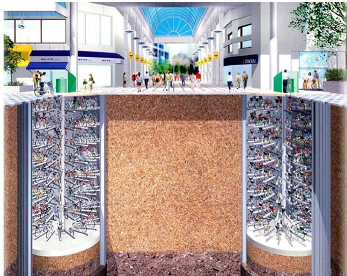
Figura 112: Estrutura de um estacionamento subterrâneo de bicicletas
