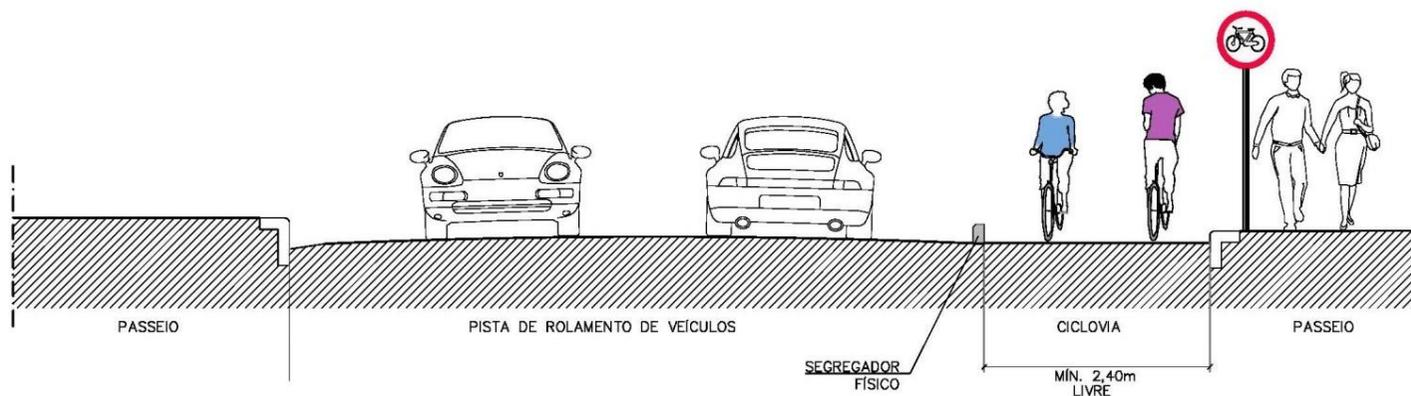
Seção 2: Ciclovia Bidirecional – Nível da via com segregador físico
