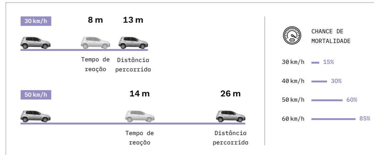
O diagrama mostra a distância necessária para frear um veículo. A probabilidade de uma fatalidade ocorrer com um veículo trafegando a 60 km/h é em torno de cinco vezes maior do que um veículo trafegando a 30 km/h.
