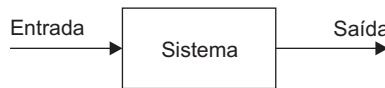
Figura 3.4 Representação em forma de Diagrama de Bloco de um Sistema, Entrada e Saída.
