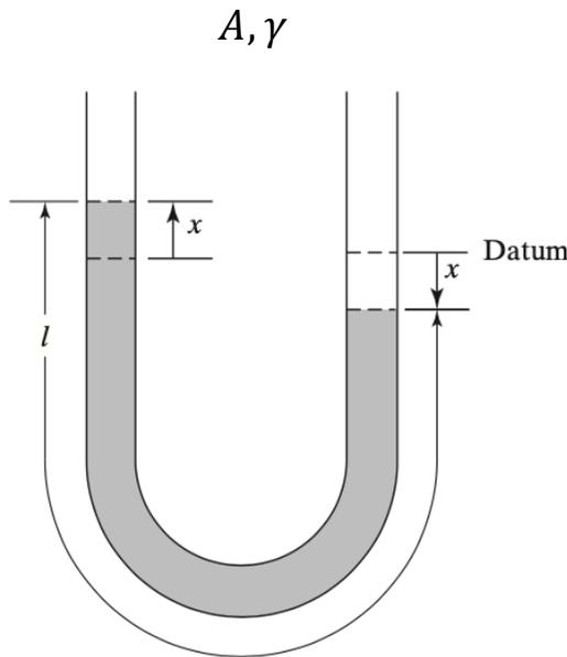
Vamos calcular a frequência natural da coluna de mercúrio pelo balanço de energia.
