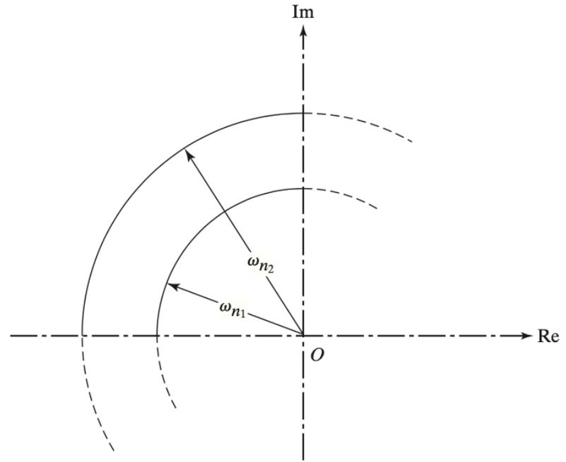
FIGURE 2.34  $\omega_n$  in  $s$ -plane.
