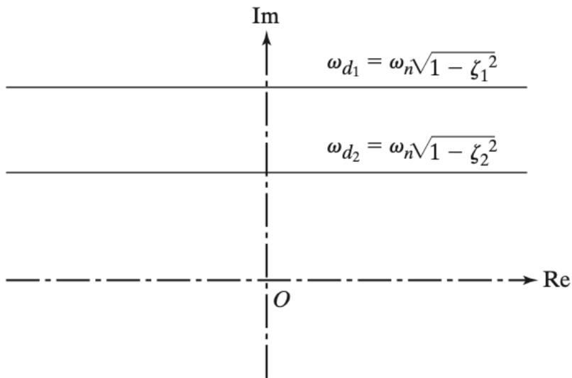
FIGURE 2.35  $\omega_d$  in  $s$ -plane.
