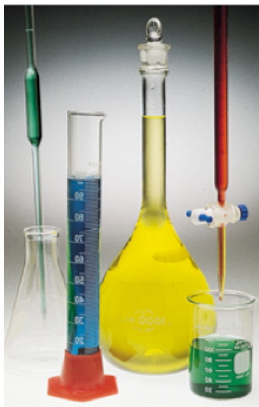
Figura 1-13 Alguns aparelhos de laboratório usados para medir volumes de líquidos: copo de 150 mL (canto inferior direito, líquido verde); Bureta de 25 mL (canto superior direito, vermelho); Balão volumétrico de 1000 mL (centro, amarelo); Cilindro graduado de 100 mL (frente esquerda, azul); e pipeta volumétrica de 10 mL (traseira esquerda, verde).
