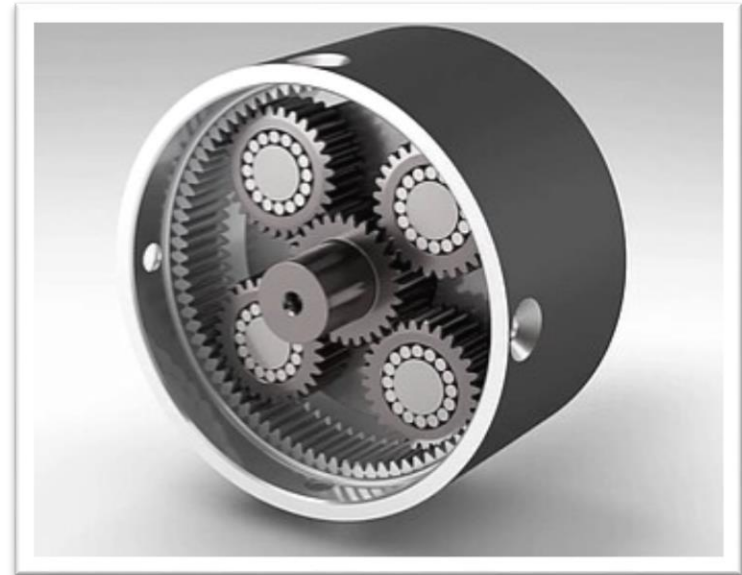
Figura 3 – Redutor planetário ou redutor de engrenagens epicicloidais.
