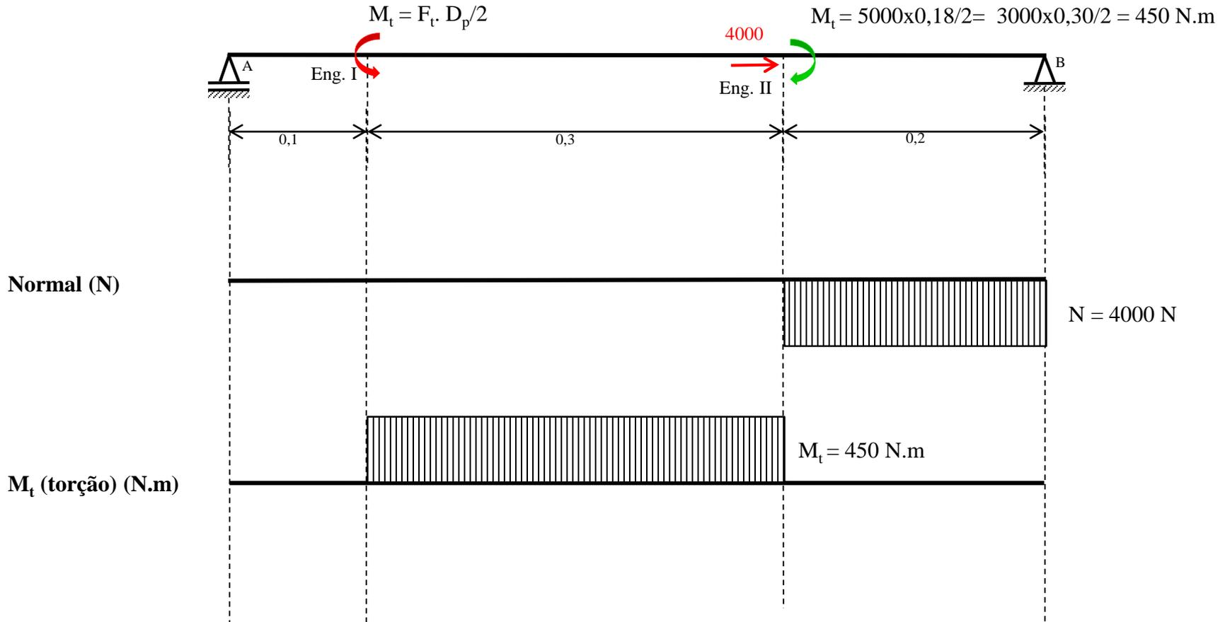
**Exercício 02:** Calcular as reações nos apoios e traçar os diagramas de esforços solicitantes para o eixo de saída de um redutor, croquis abaixo. Qual o momento fletor máximo e em que região do eixo está atuando? (dimensões em mm)
