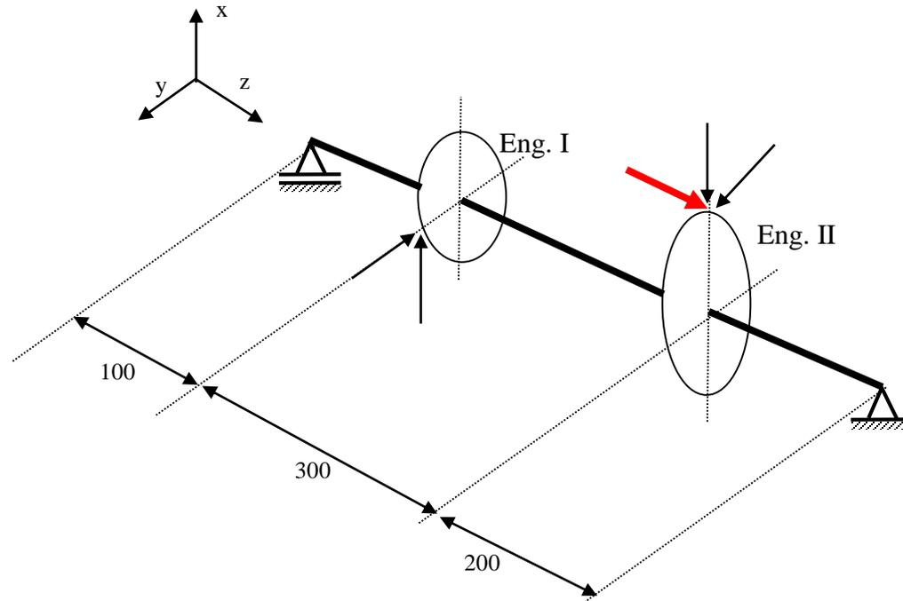
Diâmetros primitivos ( $d_p$ ) : Engrenagem I: 180 mm
